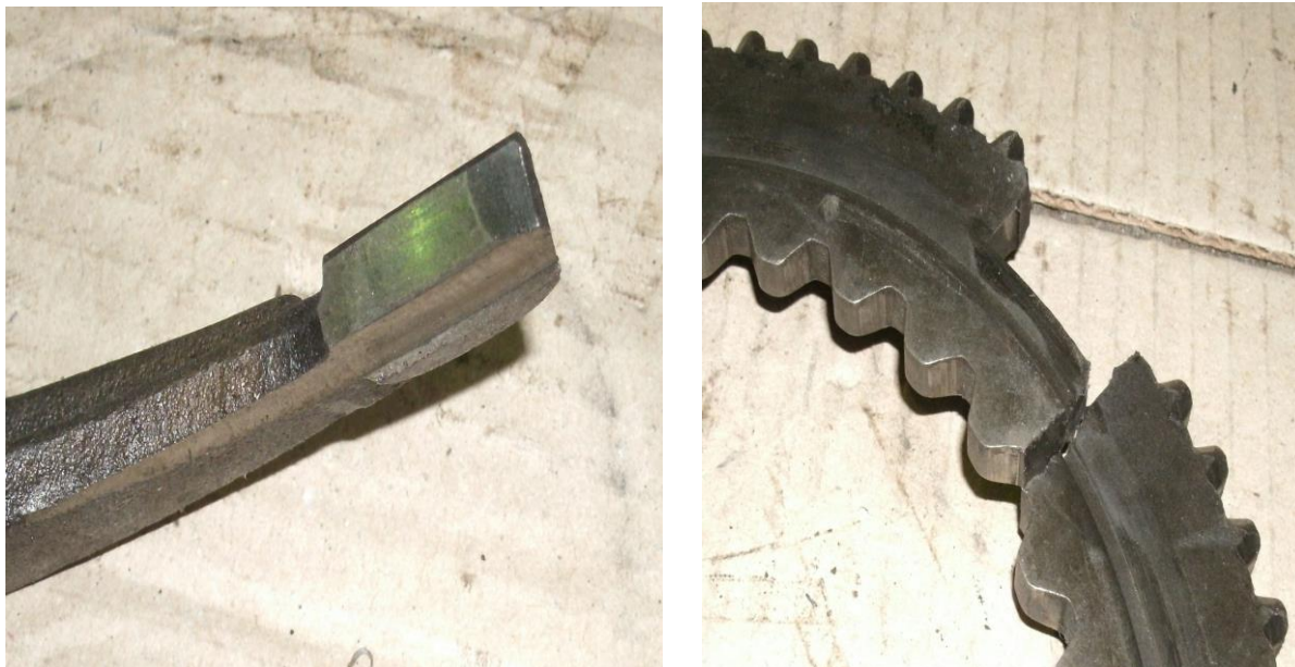
Рис. 1. Детали коробки передач: а) вилка включения; б) зубчатая муфта синхронизатора
