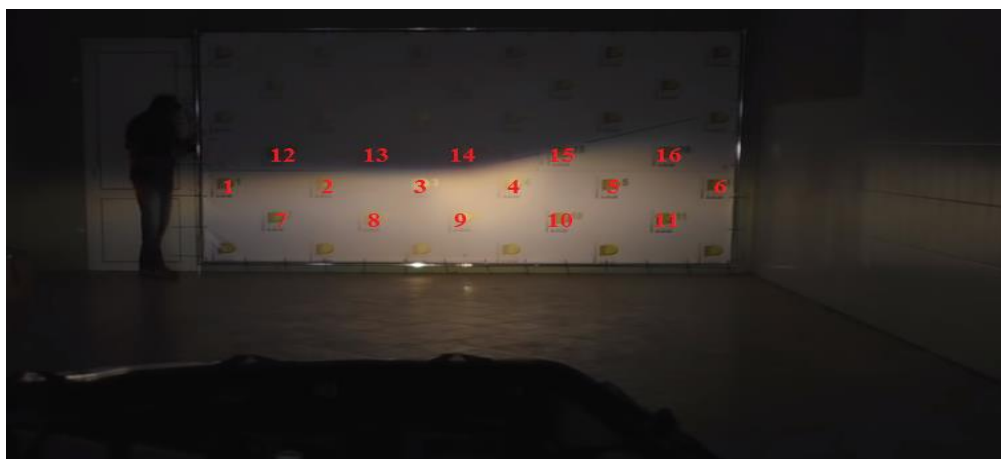
Рис. 1. Схема расположения контрольных точек измерения освещенности
