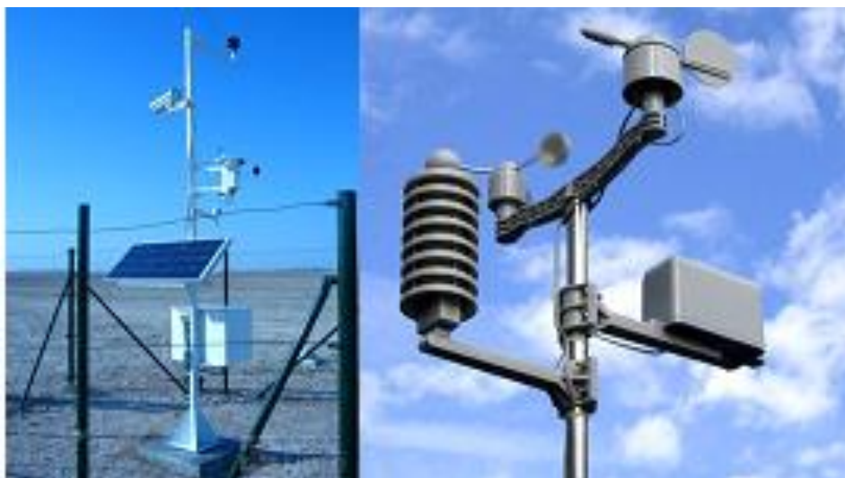
Рис. 4. Набор датчиков автоматических дорожных метеостанций
