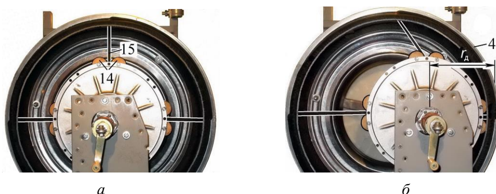
Рис. 2. Расположение ступицы по центру колеса (а) и со смещением вправо (б)
