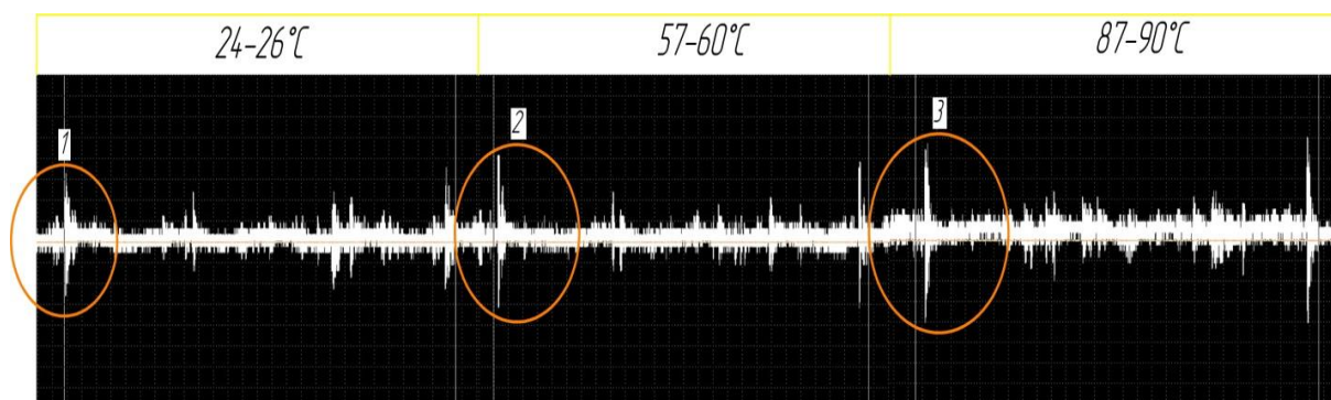
Рис. 1. Осциллограмма вибропроцесса, собранная из трех кусков с температурами: 24-26 °С; 57-60 °С; 87-90 °С
