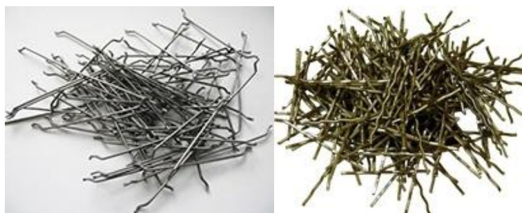
Рис. 1. Вид анкерной и металлической фибр
