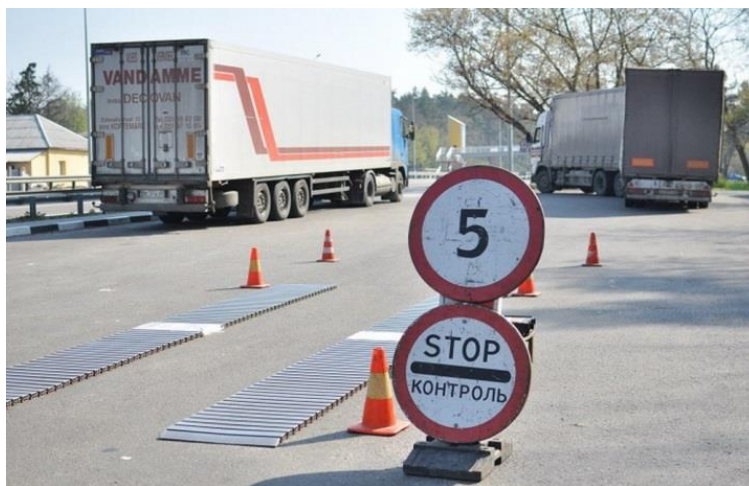
Рис. 1. Пост весового контроля
