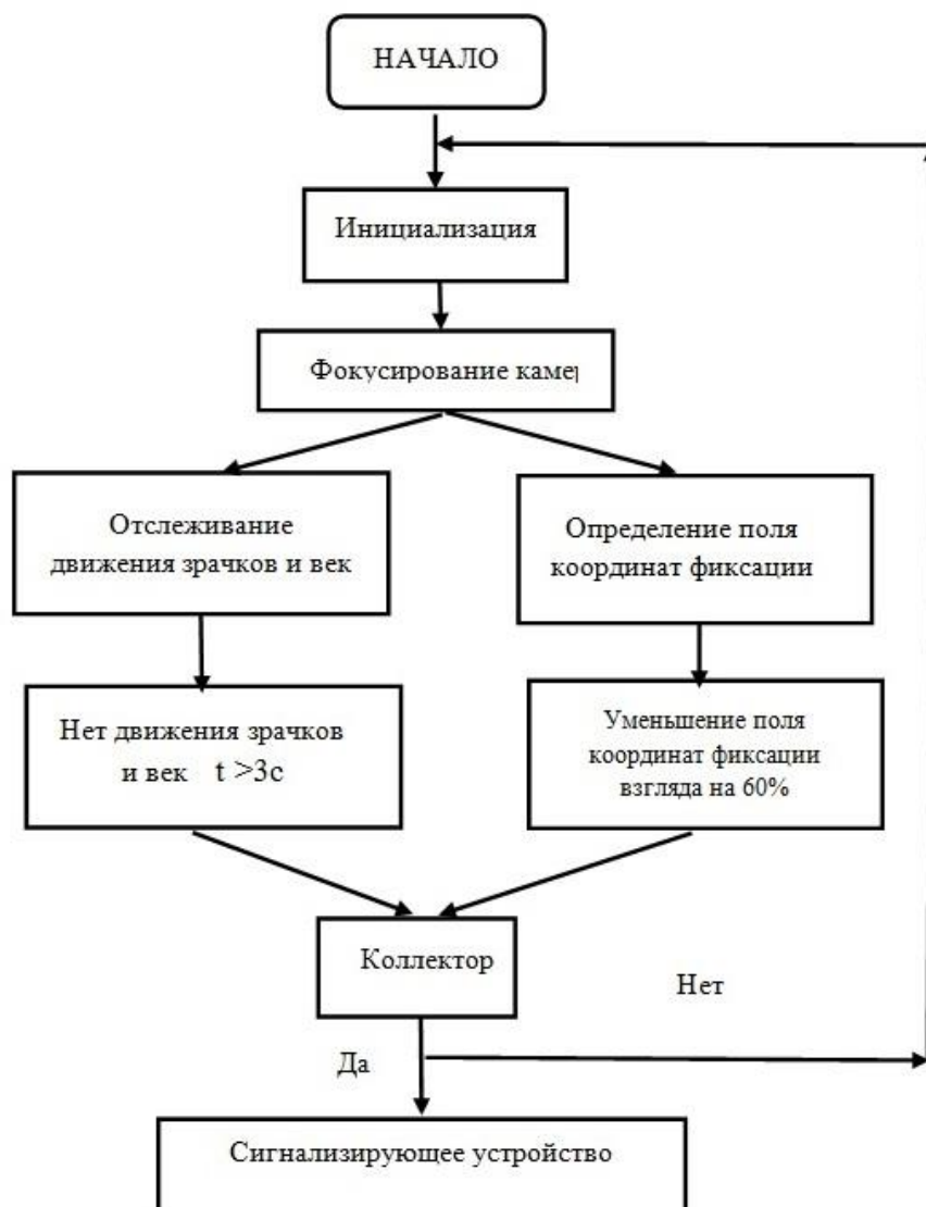
Рис. 2. Алгоритм работы устройства по определению усталости водителя ТС на базе айтрекера EyeTribe ET1000
