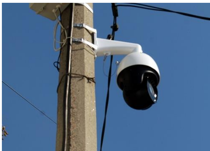
Рис. 2. Программно-аналитический комплекс «SOVA», фиксирующий нарушение правил парковки в зоне действия знака 3.27 «Остановка запрещена»
