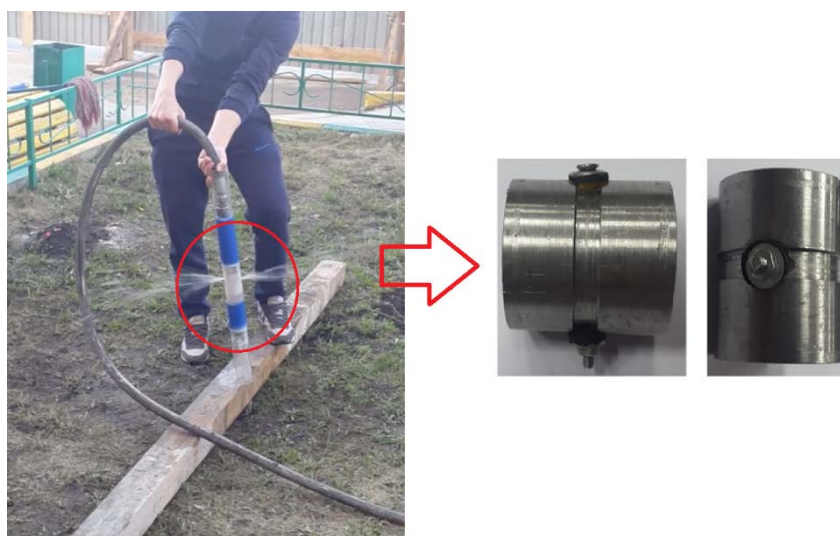
Рис. 2. Специальные конусные резинки, устанавливаемые на рабочей секции пакера для его адаптации к поршневому оборудованию
