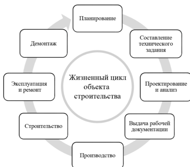
Рис. 1. Життєвий цикл об'єкта будівництва
