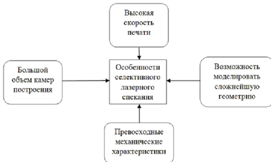
Рис. 2. Особенности селективного лазерного спекания
