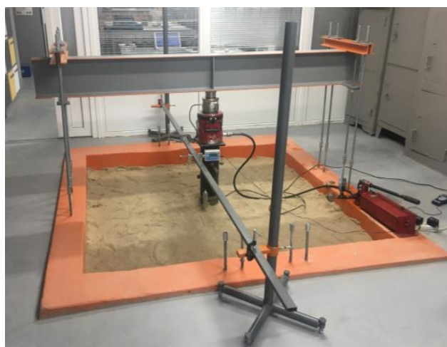
Рис. 3. Лоток в собранном виде для испытания сваи статической вдавливающей нагрузкой без опрессовки.
