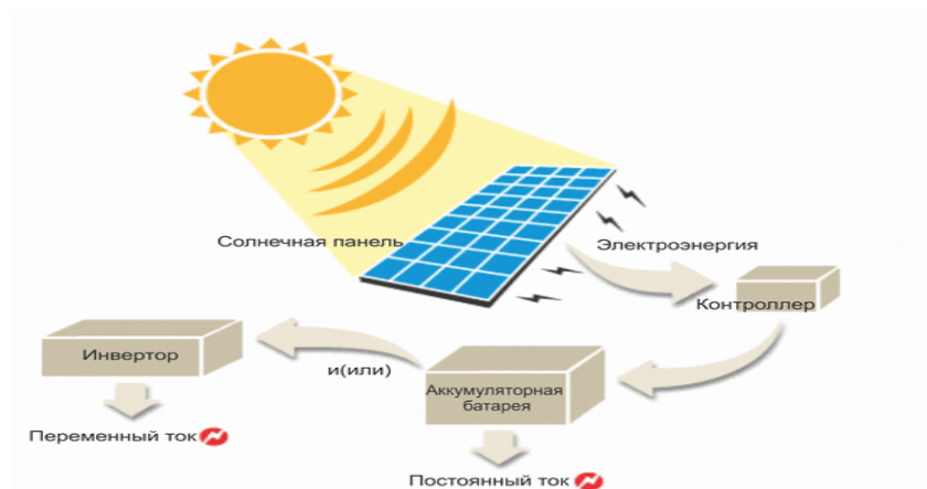
Рис. 1. Принцип работы фотоэлектрической системы
