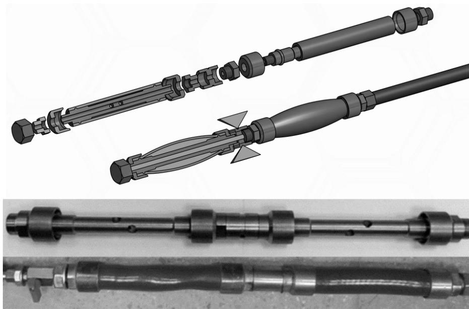
Рисунок 2. Конструкция и схема работы новой конструкции пакера
