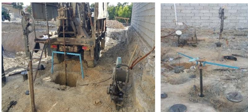
Рисунок 5. Вид прессиометрических и штамповых испытаний для определения модуля деформации грунтов.
