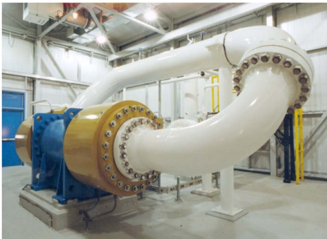
Рис. 1. Фото агрегата в едином корпусе (ЭГПА-8,2/8600-56/1,44-Р «Лысьва-МБ-8,2»)
