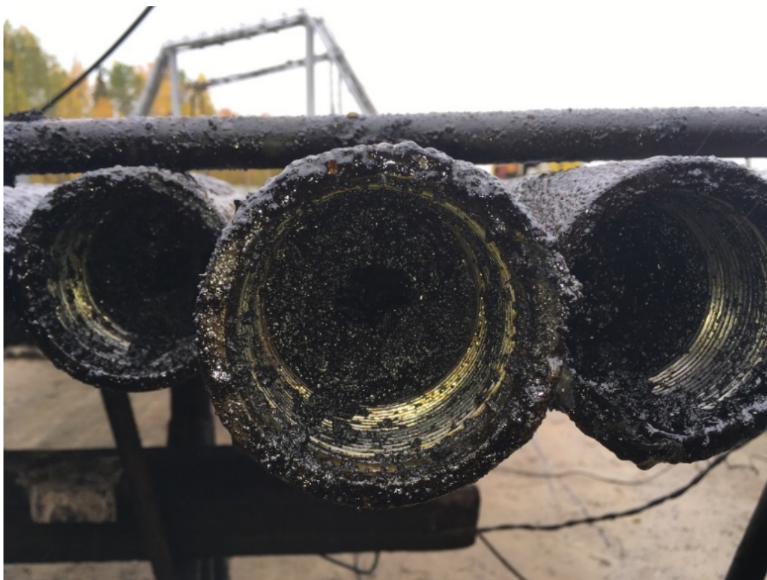
Рис. 1. Отложения парафина на стенках НКТ, в процессе эксплуатации
