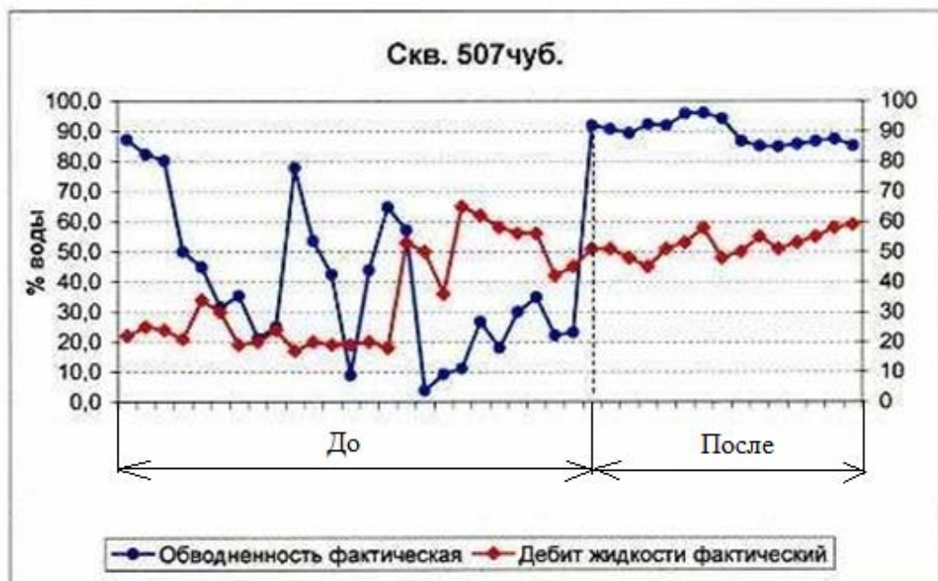
Рисунок 1. Диаграмма изменения обводненности нефти до и после установки пробоотборника со статическим смесителем [3]
