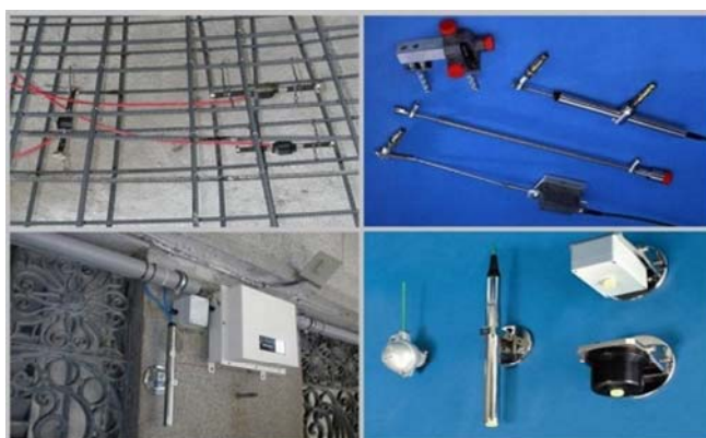
Рисунок 5. Тензометры, датчики контроля
