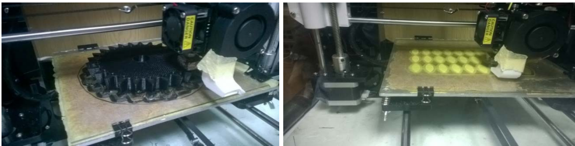
Рисунок 2. Изготовление инструмента на 3D принтере
