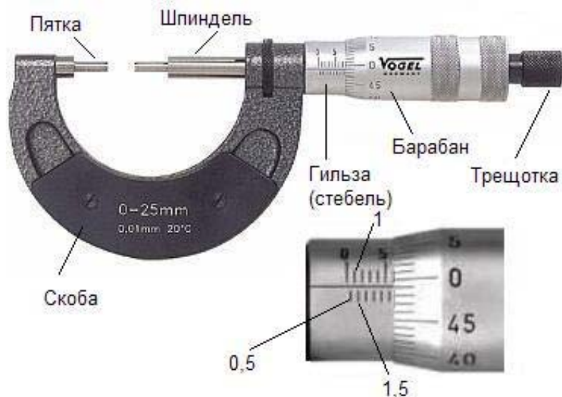
Рисунок 2. Общий вид микрометра
