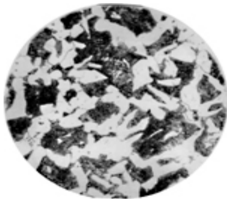
Рисунок 1. Микроструктура стали 35 (x 500)
