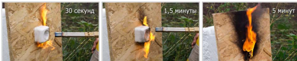
Рисунок 2. Эксперимент по возгоранию электропроводки
