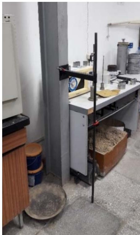
Рисунок 1. Схема и фотография крепления стержня 1 – элемент крепления; 2 – гиря, массой 2,5 кг; 3 – стержень; 4 – плунжер; 5 – разъемный цилиндр
