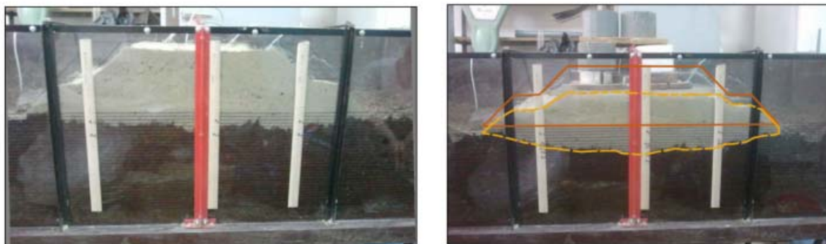
Рисунок 1. Насыпь без армогрунтовой обоймы
