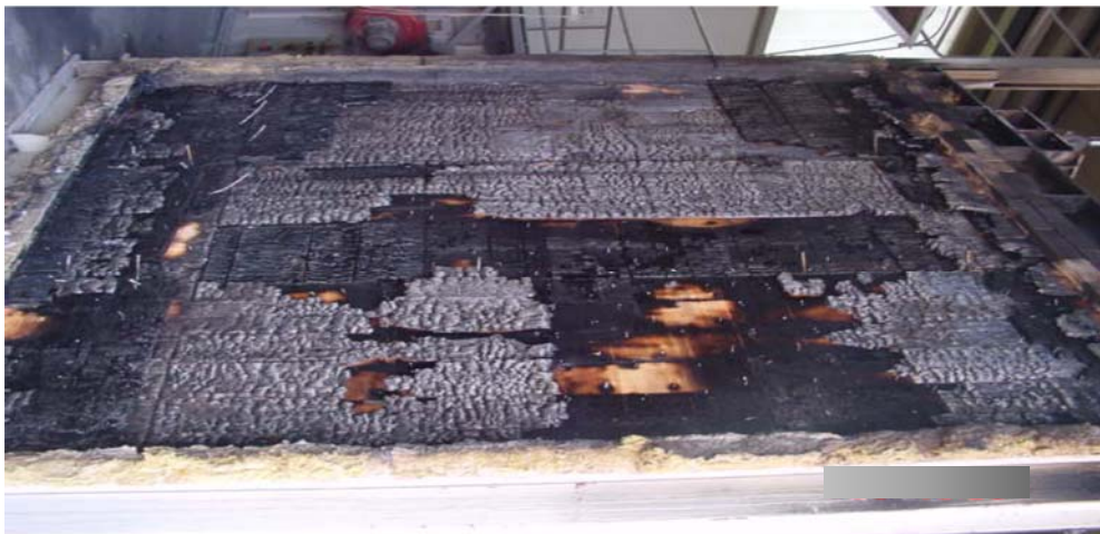
Рисунок 2. Испытание на измерение огнестойкости в лаборатории строительных материалов
