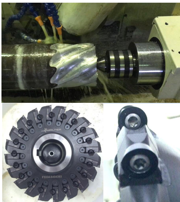
Рисунок 1. Обработка ротора ВЗД сборной дисковой фрезой
