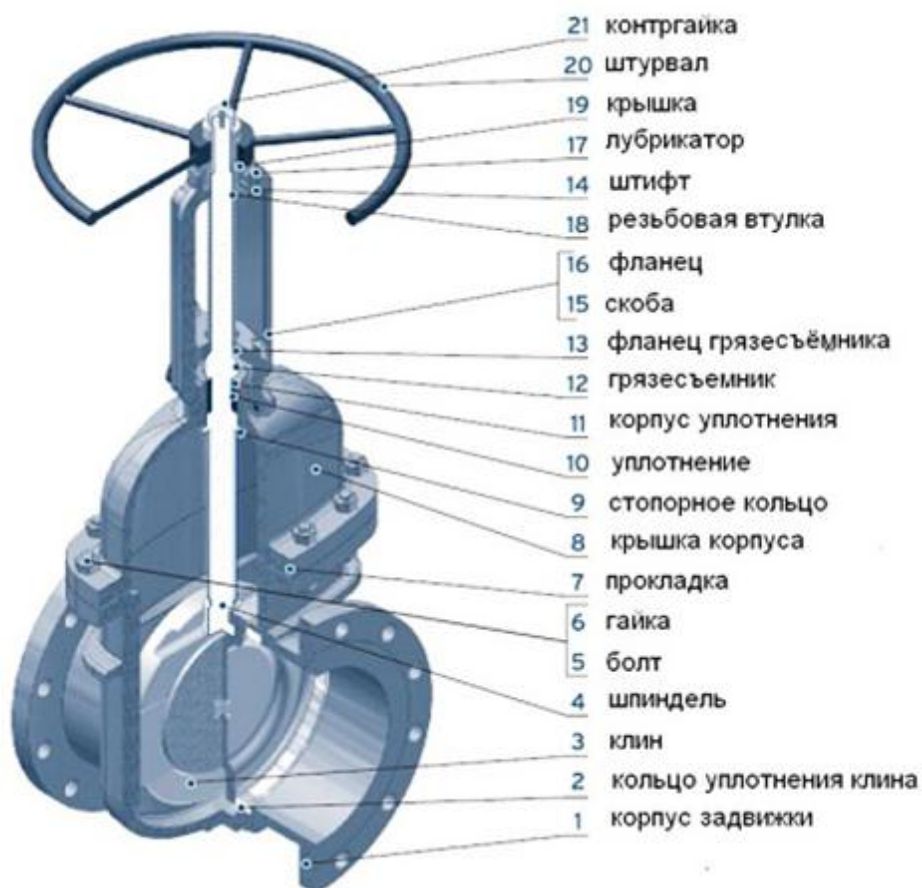
Рис. 1. Модель стальной клиновой задвижки
