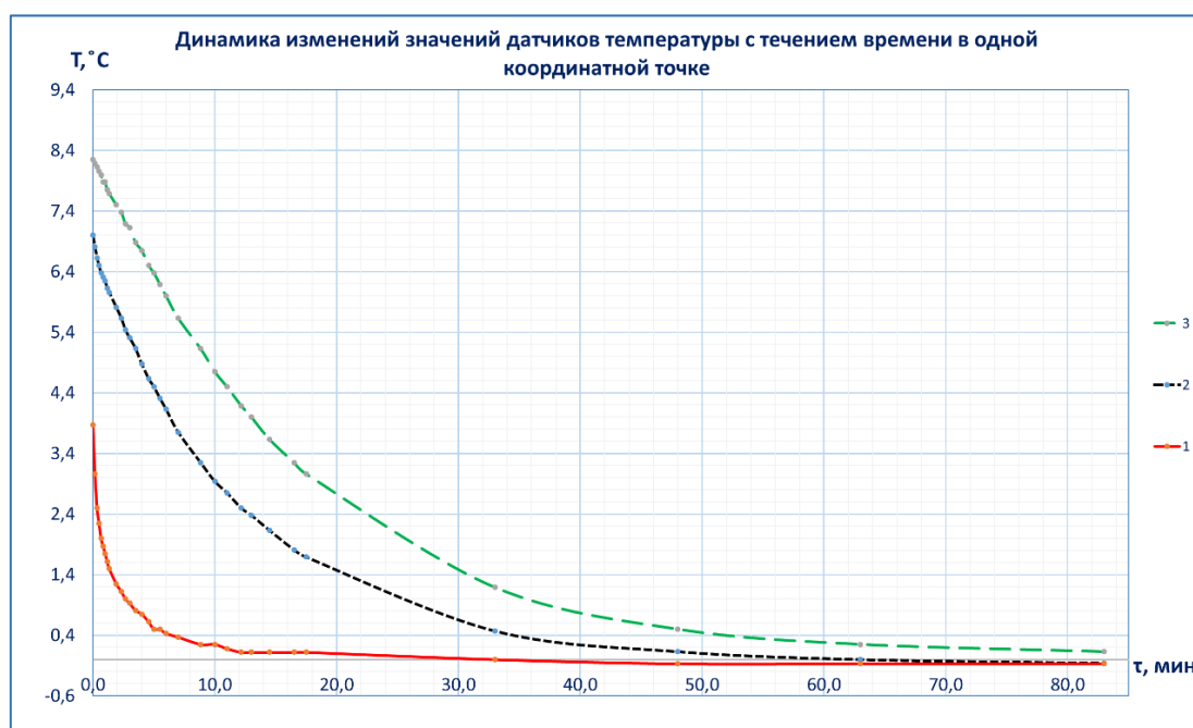
Рис. 1. Графики изменения значений температуры датчиков с течением времени. 1-контакт с грунтом (сплошная линия); 2-контакт через стенку (короткий пунктир); 3-датчик в воздухе (длинный пунктир)
