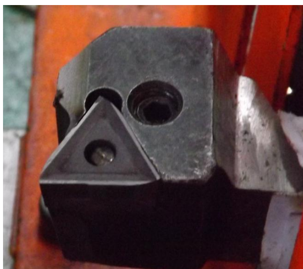
Рис. 5. Фотография реза с разработанной режущей пластиной повышенной прочности
