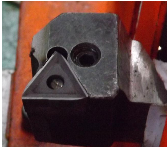
Рис. 5. Фотография реза с разработанной режущей пластиной повышенной прочности
