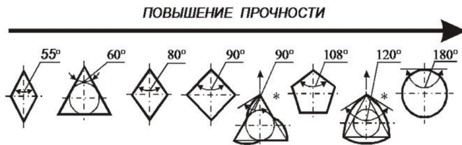
Рис. 1. Классификация форм СМП по прочности в зависимости от величины угла при вершине \epsilon (*новые формы пластин представленные в работах [3])
