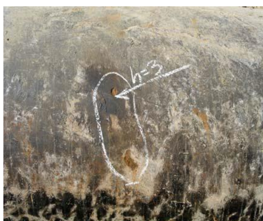
Рис.1. Питтинговая коррозия на поверхности трубопровода (а) и зависимость скорости локальной коррозии от содержания КАНВ (б)
