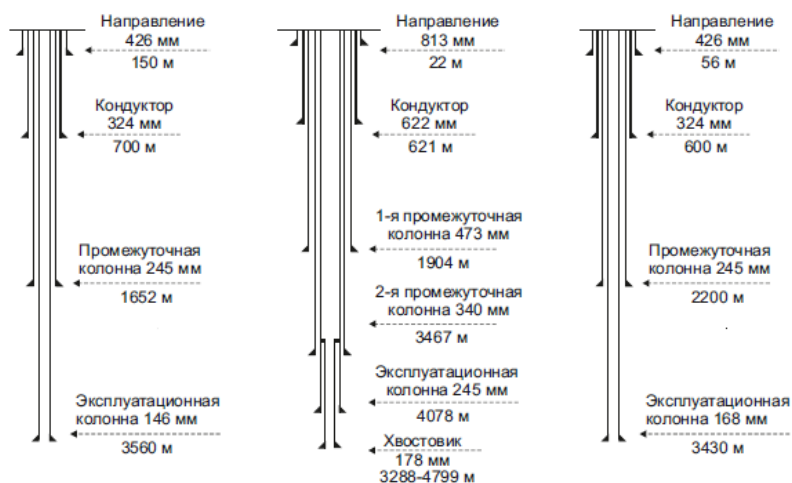
Рисунок 2. Конструкция разведочных (поисковых) скважин после 1993
