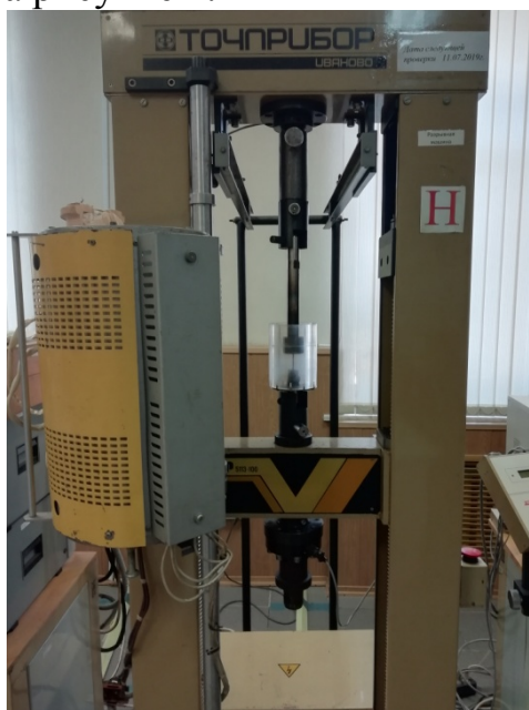
Рисунок 2. Коррозионная ячейка, установленная на разрывную машину
