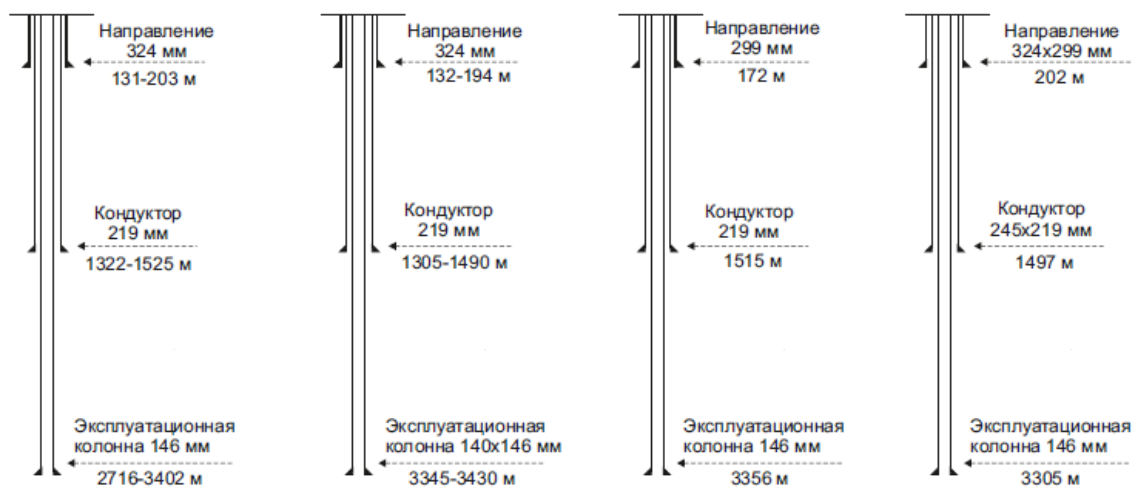
Рисунок 1. Конструкция разведочных (поисковых) скважин до 1993
