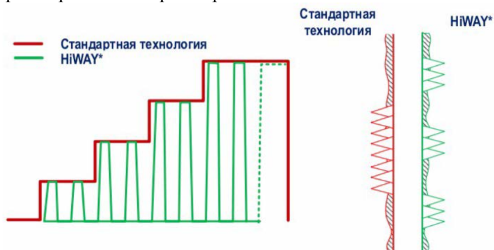
Рисунок 1. Технологии закачка пропантa при стандартном ГРП и HiWAY
