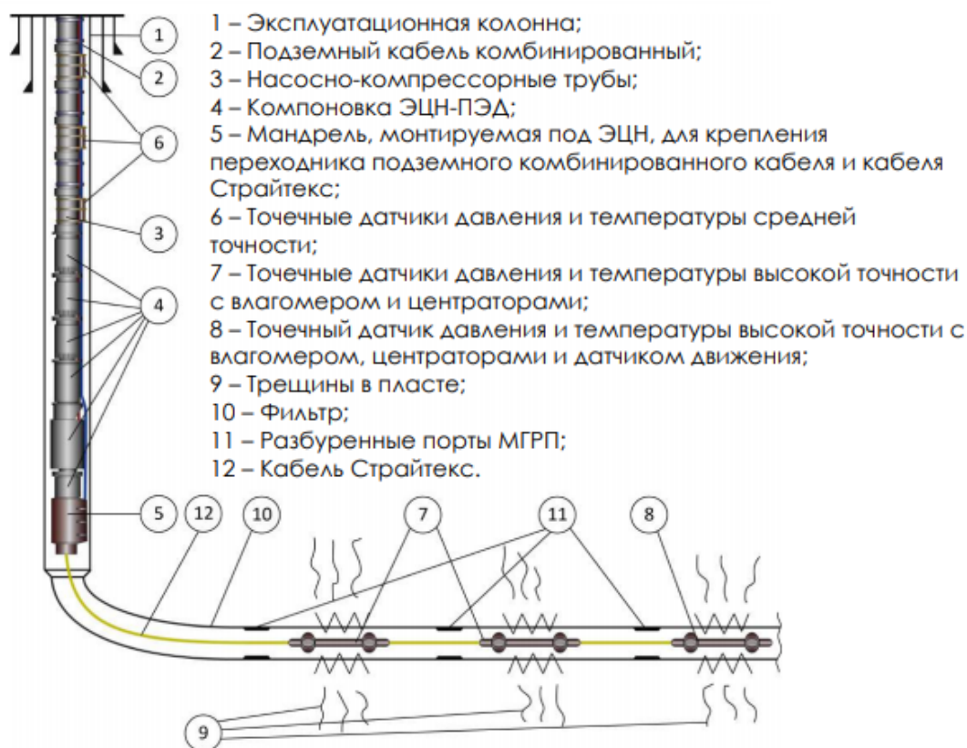
Рисунок 1. Подземное оборудование технологии
