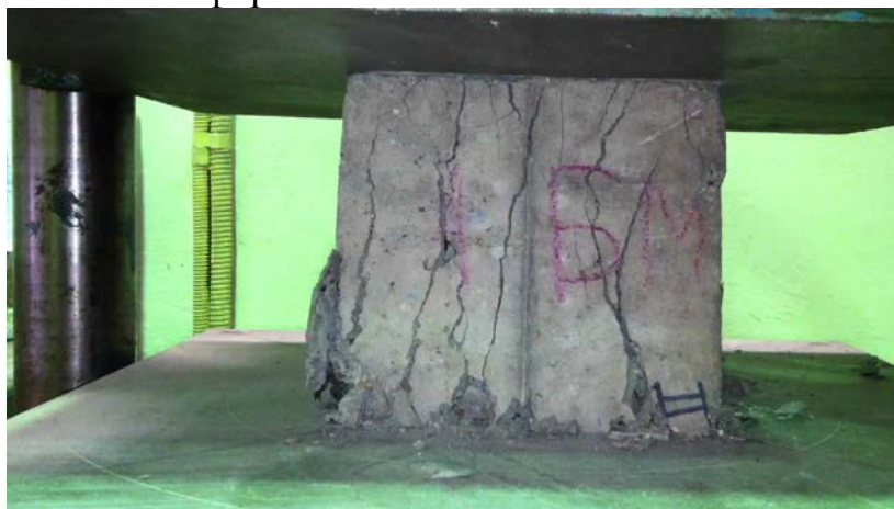
Рисунок 2. Разрушение цементного камня
