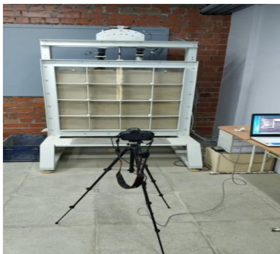
Рисунок 1. Общий вид установки для испытаний свай
