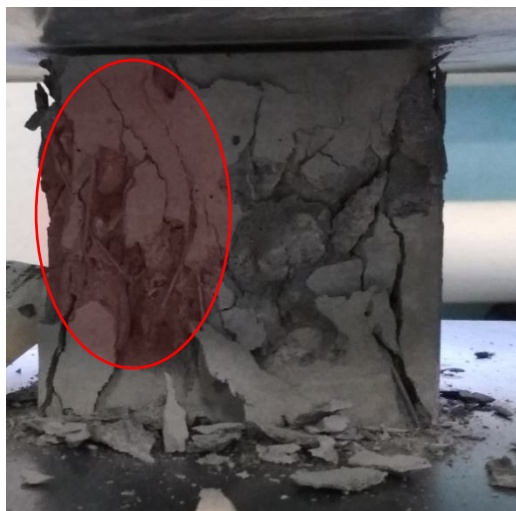
Рисунок 2. Разрушенный образец бетона с добавлением стальной фибры
