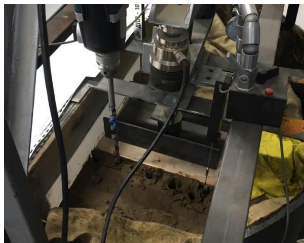
Рисунок 2. Процесс выбуривания грунта
