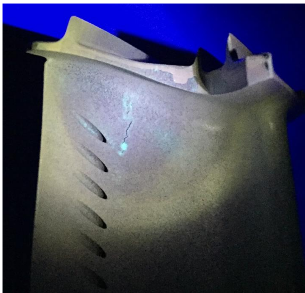
Рисунок 1. Внешний вид дефекта лопатки №1
