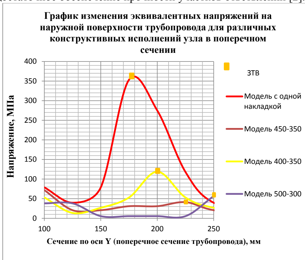
Рисунок 2. График изменения эквивалентных напряжений
