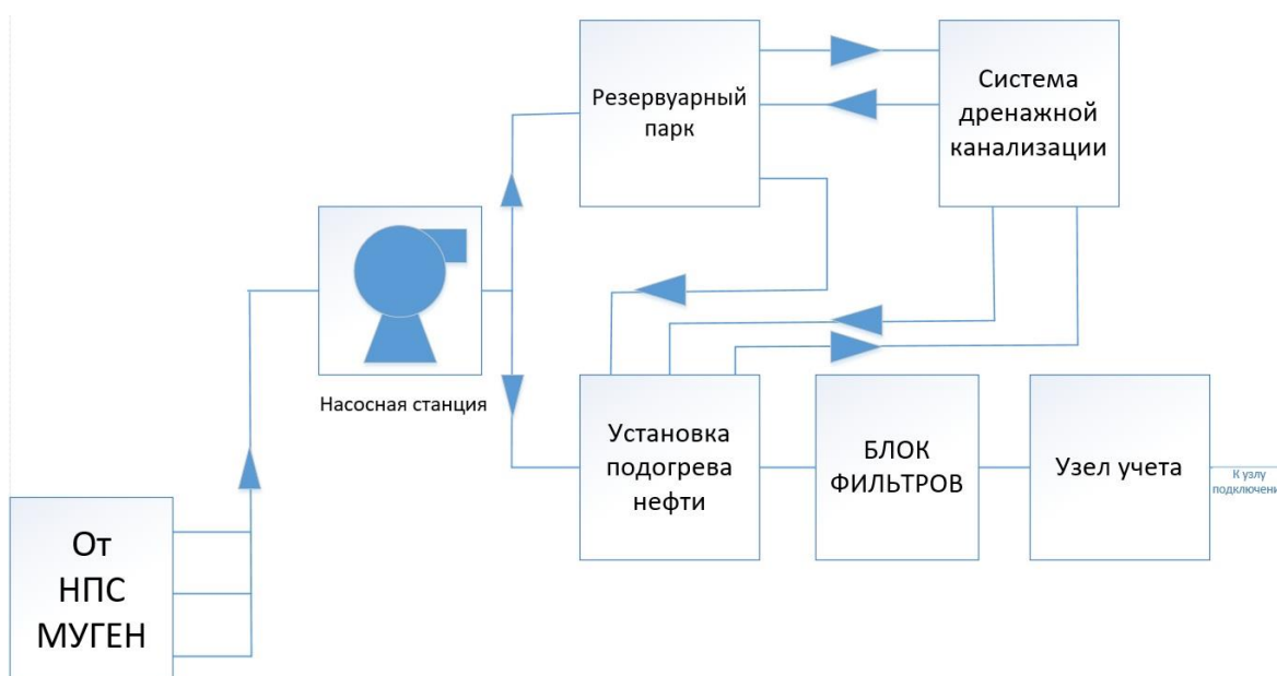
Рисунок 2. Типовая структурная схема приёмно-сдаточного пункта нефти.
