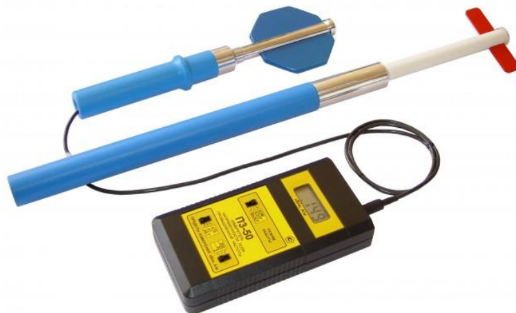
Рисунок 1. Измеритель напряженности поля промышленной частоты ПЗ-50 Результаты измерения представлены в таблице 1.
