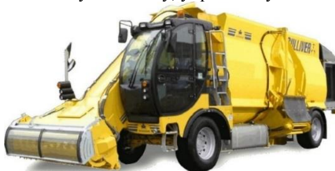
Рисунок 1. Самоходный кормосмеситель фирмы Sgariboldi Gulliver 6000
