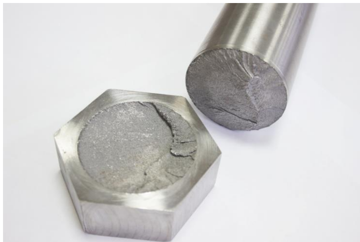
Рисунок 1. Вид разрушенного призонного болта
