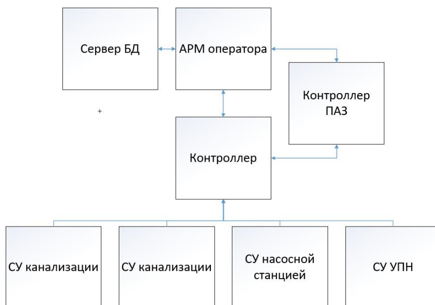
Рисунок 3. Структурная схема системы управления приёмно-сдаточным пунктом нефти.
