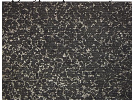
Рисунок 2. Микроструктура стали 25Х1МФ (x50)
