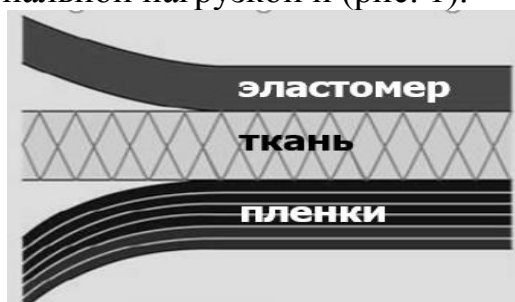
Рисунок 1. Схема структуры материала полимерного резервуара
