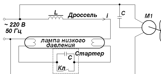
Рисунок 2. Электронная схема воздухоочистителя
