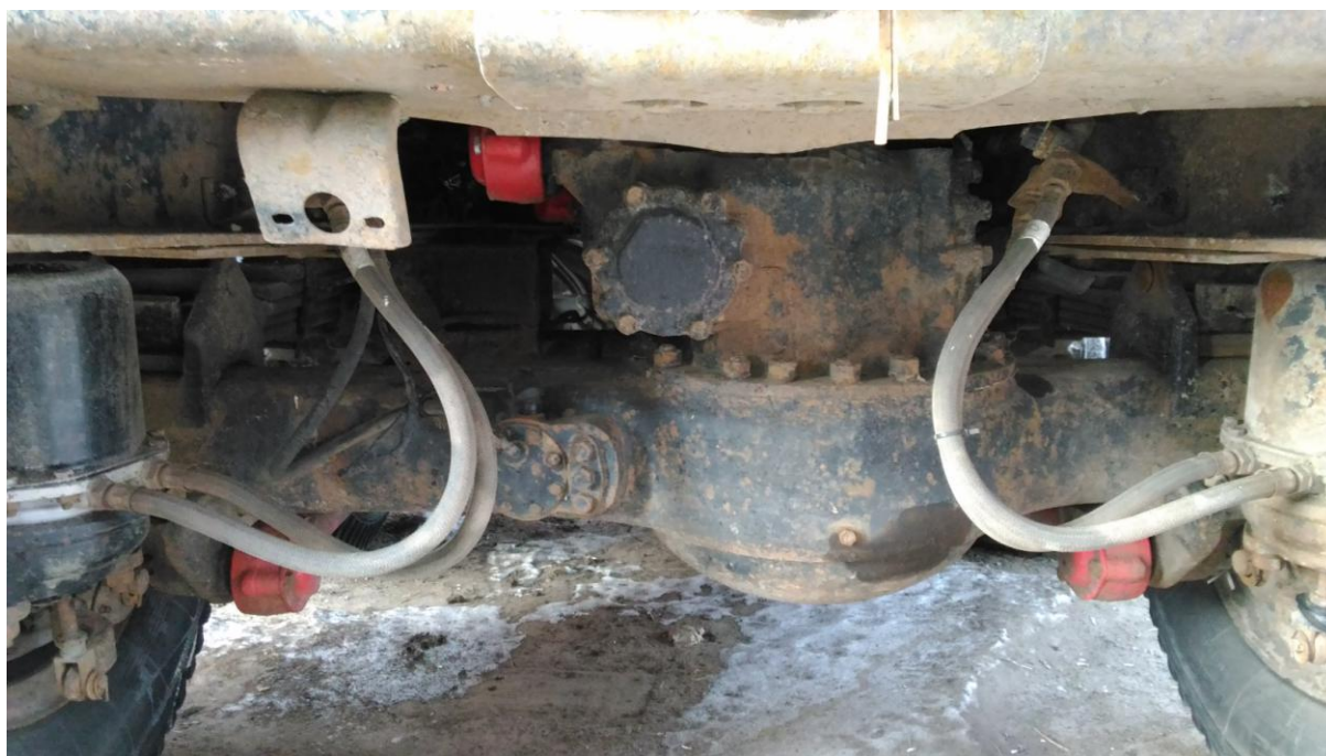
Рис. 1. Задний ведущий мост автомобиля-самосвала КАМАЗ-65115
