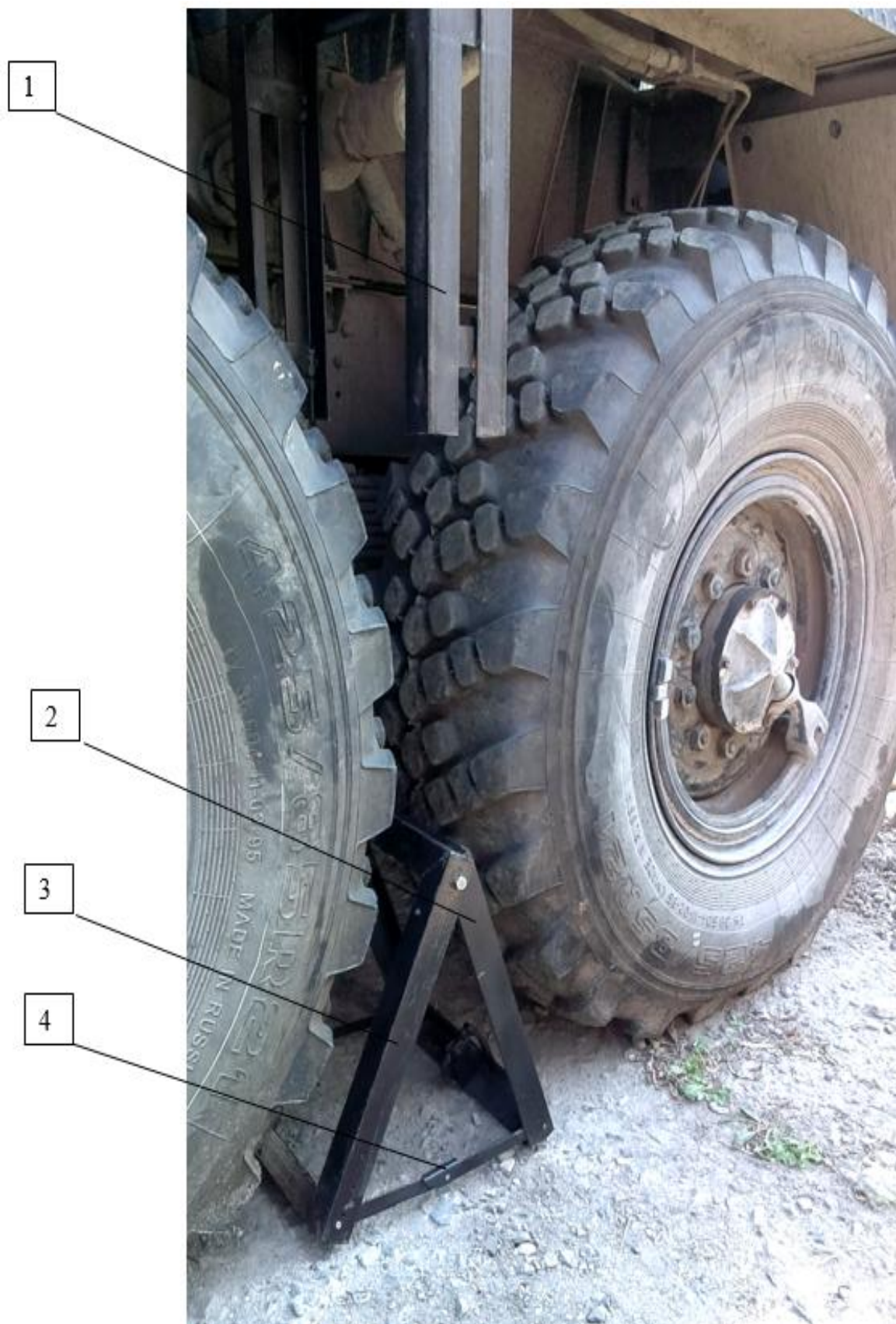
Рис. 2. Горный тормоз рамочного типа после контакта с дорогой: 1 – кронштейн подвески опорной рамы в транспортном положении; 2 – внутренняя рамка опорной рамы; 3 – внешняя рамка опорной рамы; 4 – складывающийся фиксатор опорной рамы в рабочем положении
