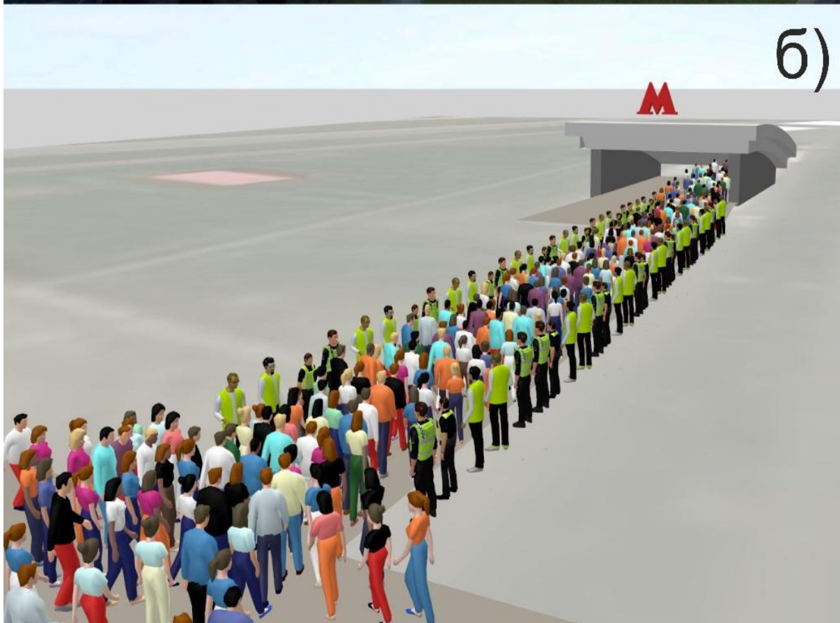
Рис. 1. Пример канализирования пешеходных потоков перед входом на ст. м. «Спартак» а) кадр видеосъемки; б) модельная 3D визуализация
