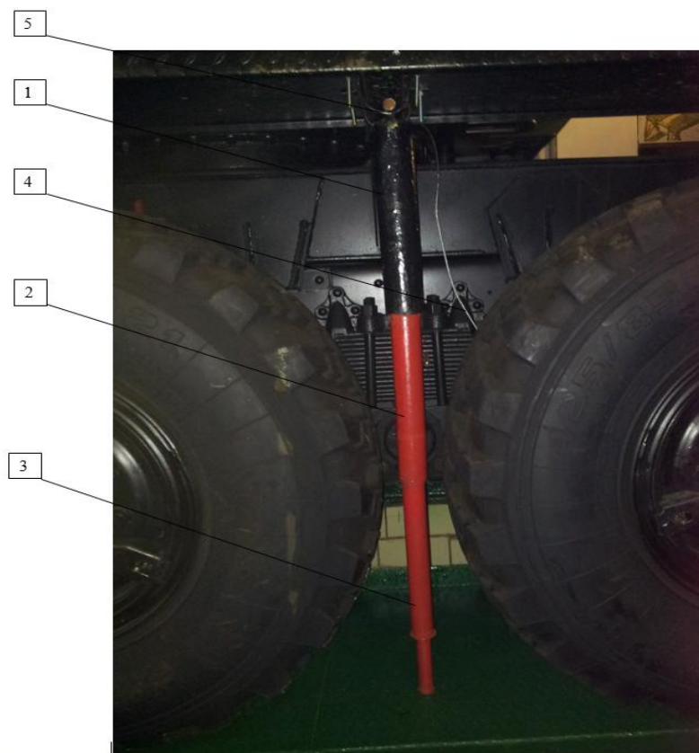
Рис. 1. Горный тормоз телескопического типа: 1 – базовый цилиндр; 2 – средний цилиндр; 3 – прочный стержень; 4 – тросик; 5 – плоская скоба крепления
