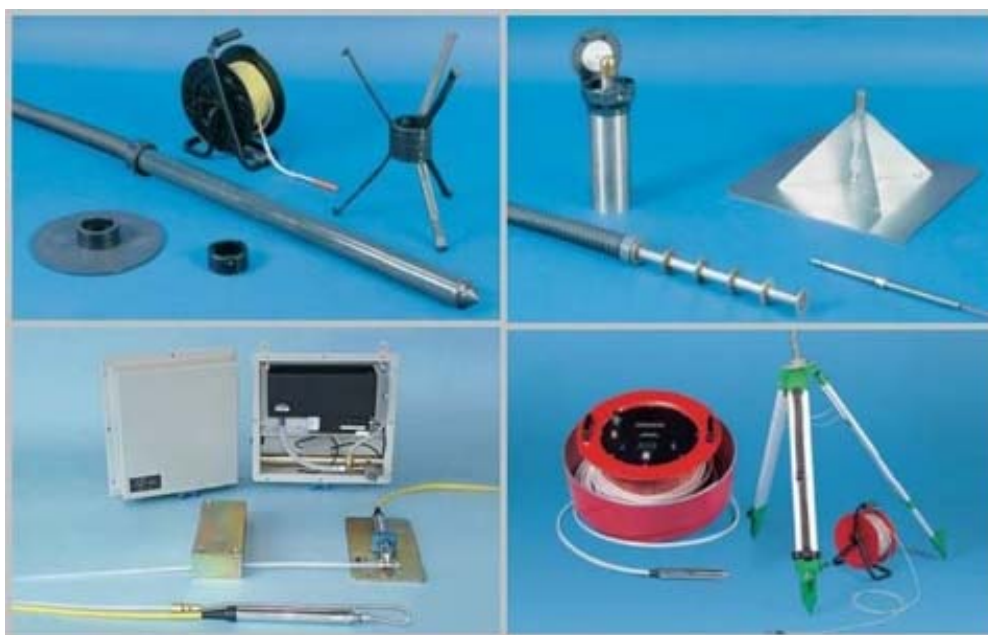
Рисунок 2. Экстензометр и его составляющие
