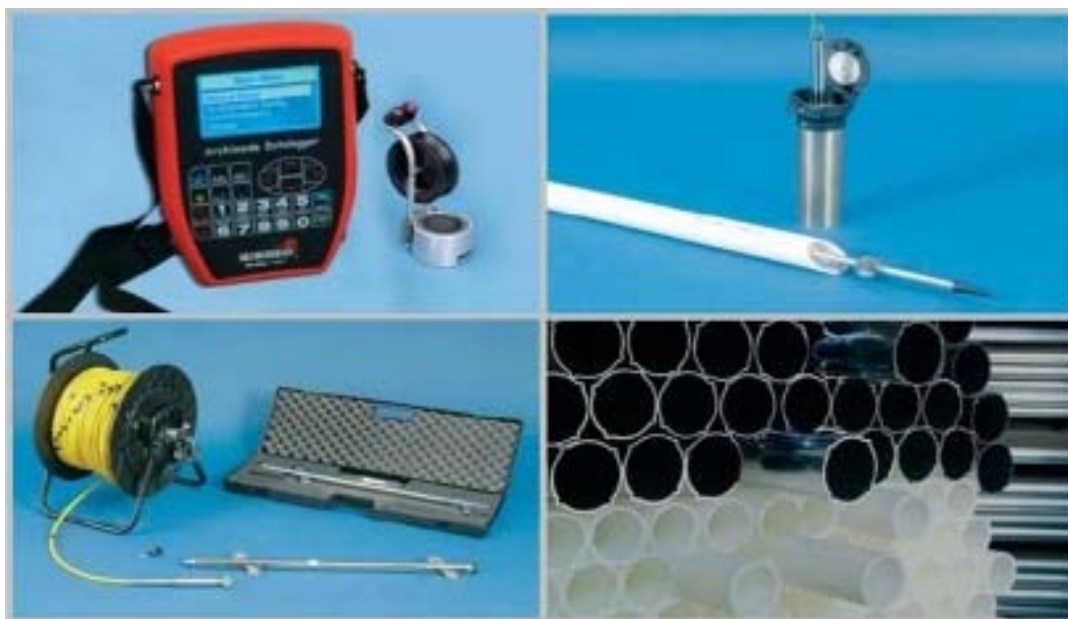
Рисунок 1. Инклинометр и его составляющие
