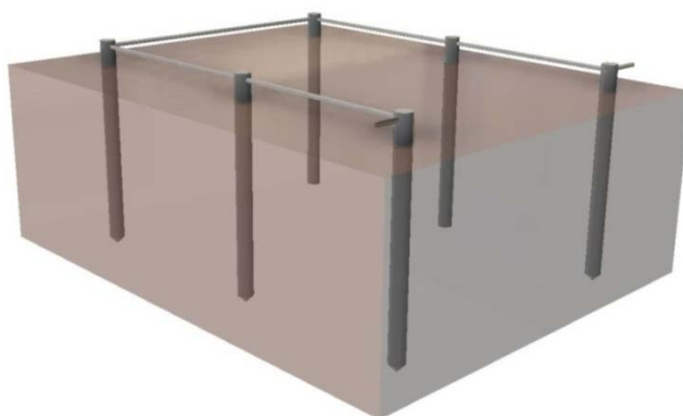
Рисунок 3. Возможная схема расположения свайного поля в массиве грунта с применением принудительно охлаждающих свай
