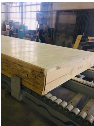
Рис. 3. Готовая каркасно-стеновая панель
