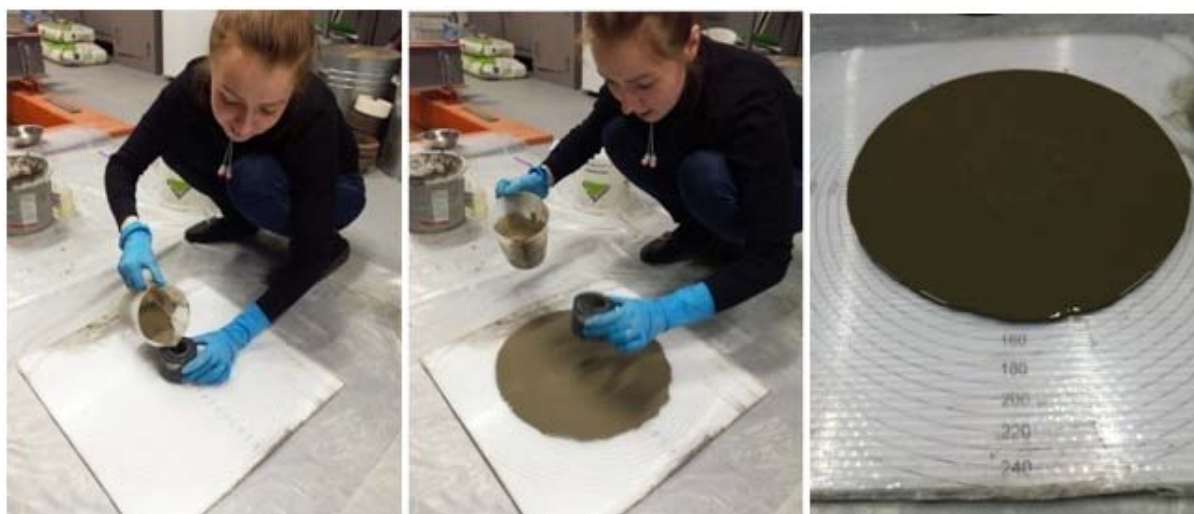
Рисунок 1. Лабораторные исследования растекаемости раствора
