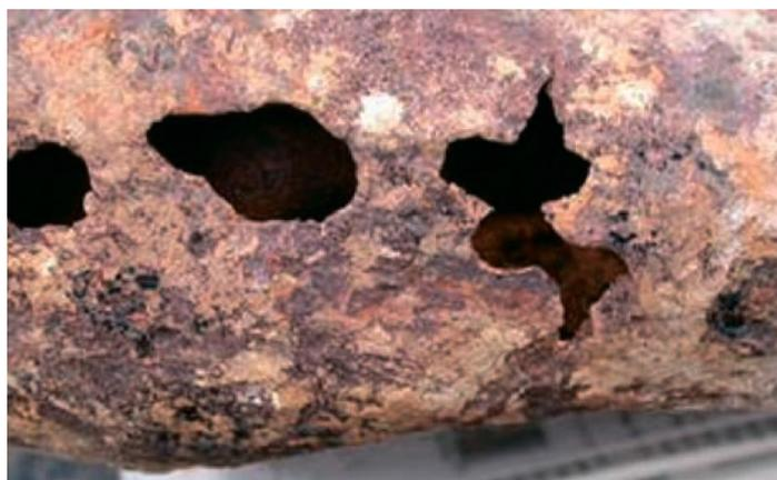
*Рис. 1. Последствия коррозионного износа трубопровода*
