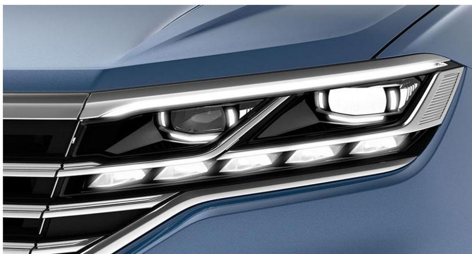
*Рис. 1. Легкие светодиодные матричные адаптивные фары, основанные на модулях управление фар дальнего света.*
