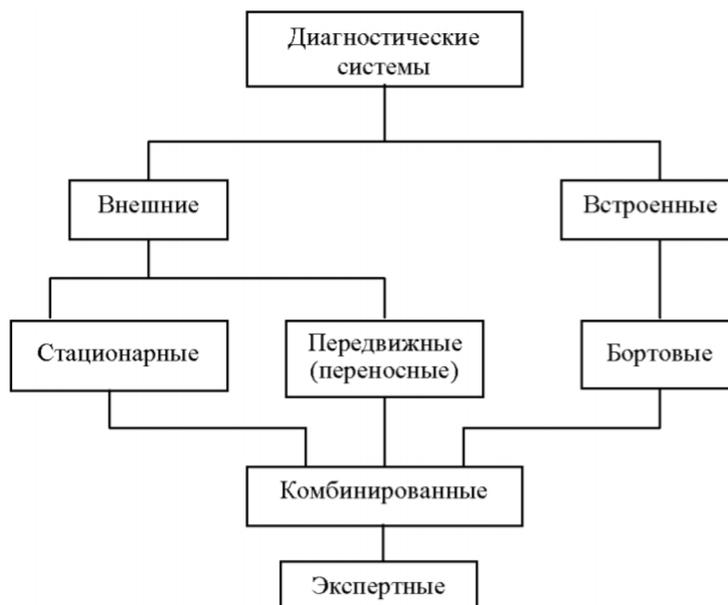
Рис.1. Классификация диагностических устройств в зависимости от места расположения технических средств диагностирования по отношению к автомобилю
