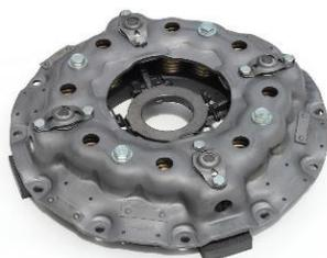
Рис. 1. Сцепление автомобиля КАМАЗ-43118
