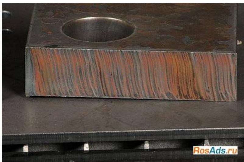
Рисунок 3. Кромка металла после реза плазменного резака
