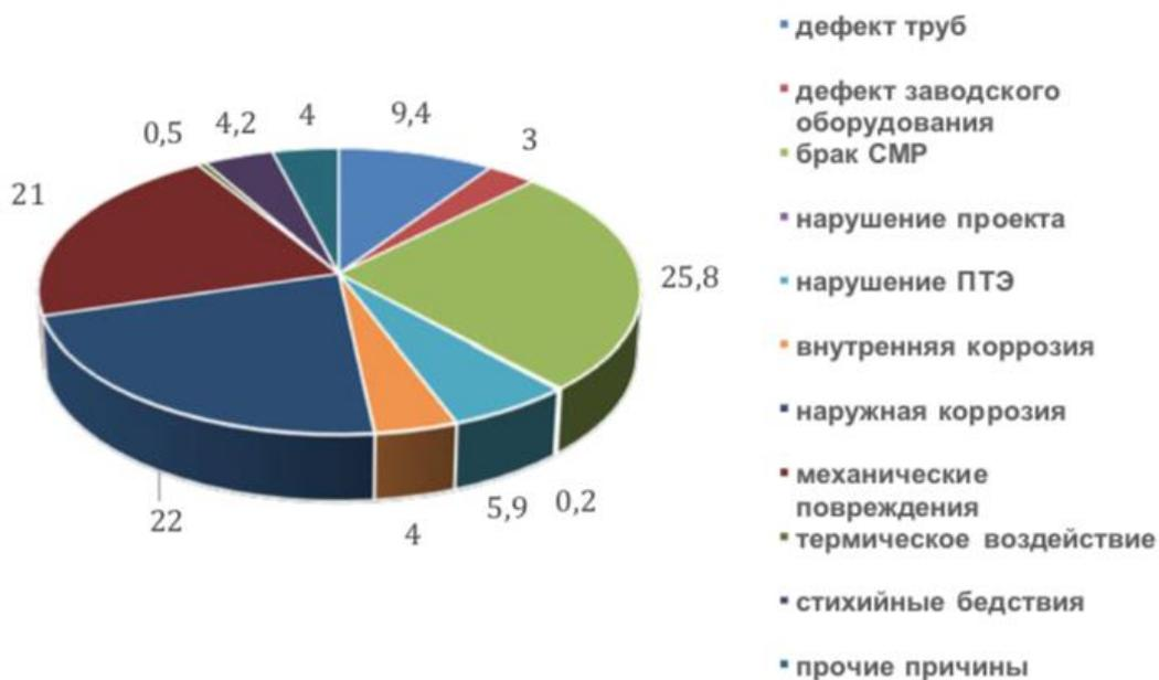
Рис. 1. Аварии на линейно части магистральных газопроводов в зависимости от причин возникновения
