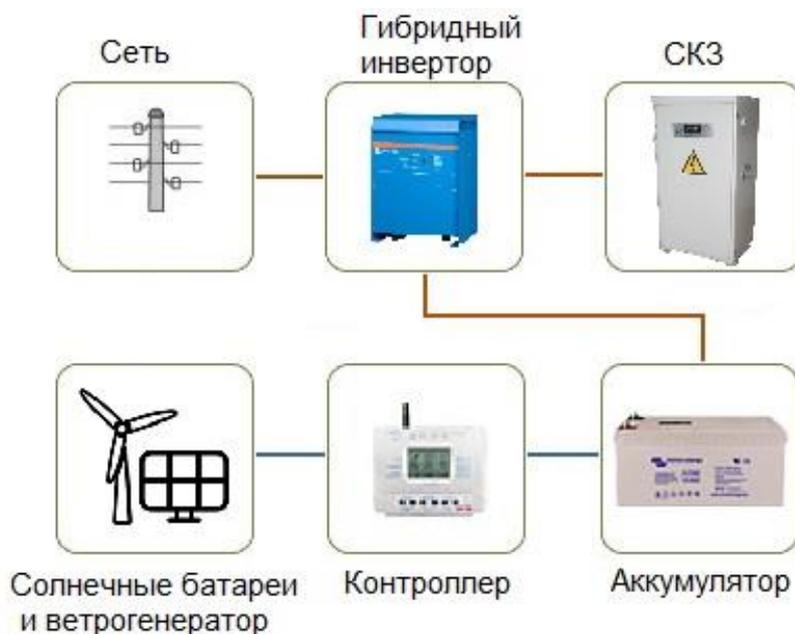
Рис. 2. Схема подключения солнечно-ветровой электроустановки
