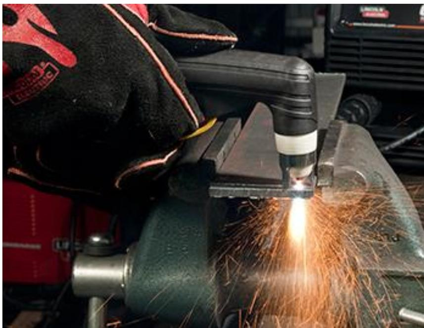
*Рис 1. Аппарат воздушно-плазменной резки*
