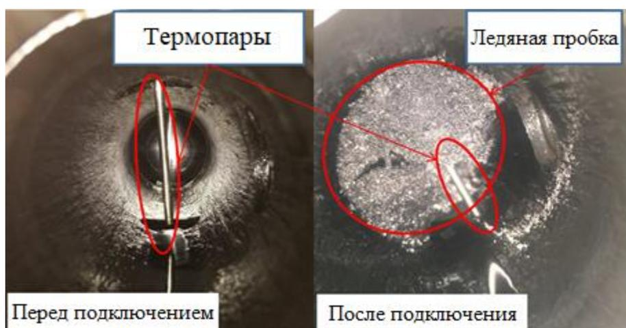
Рис. 1. Пробка льда на вставленной термопаре
