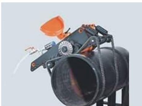
Рис. 1. Машины для безогневой резки труб МРТ 325-1420 мм «Волжанка - 3»
