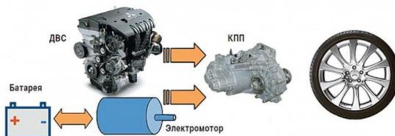
Рис. 2. Схема силовой установки параллельного гибрида
