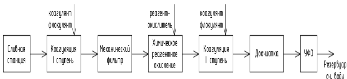
Рисунок 1 – Возможная схема физико-химической очистки привозных стоков с септиков северного населенного пункта
