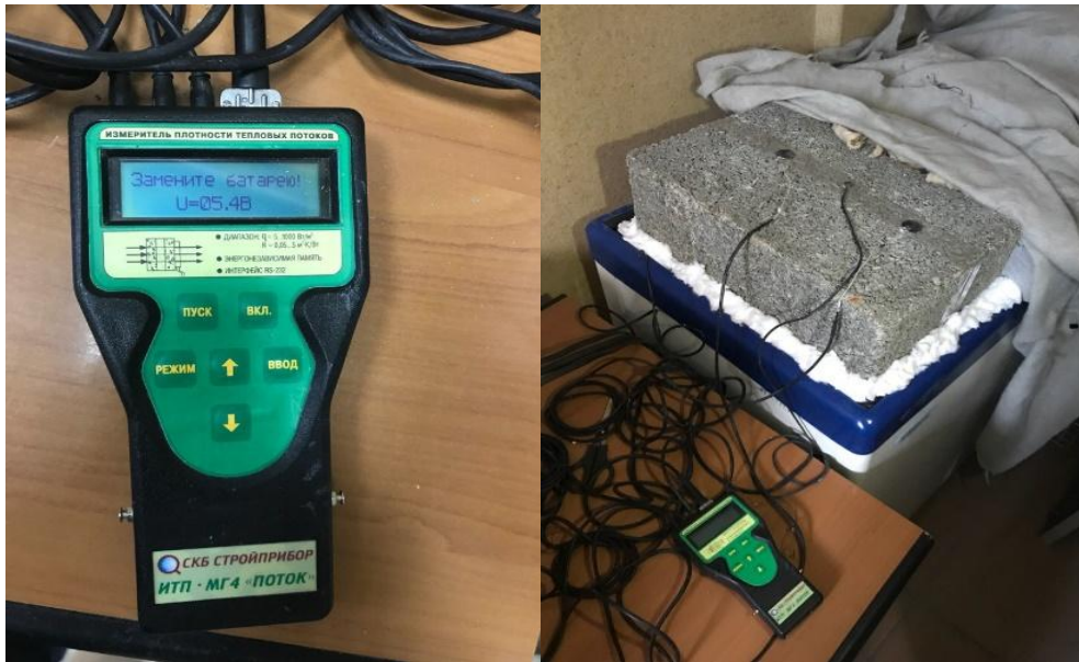
Рисунок 1 – Прибор для определения теплотехнических характеристик ИТП МГ4 «Поток»
