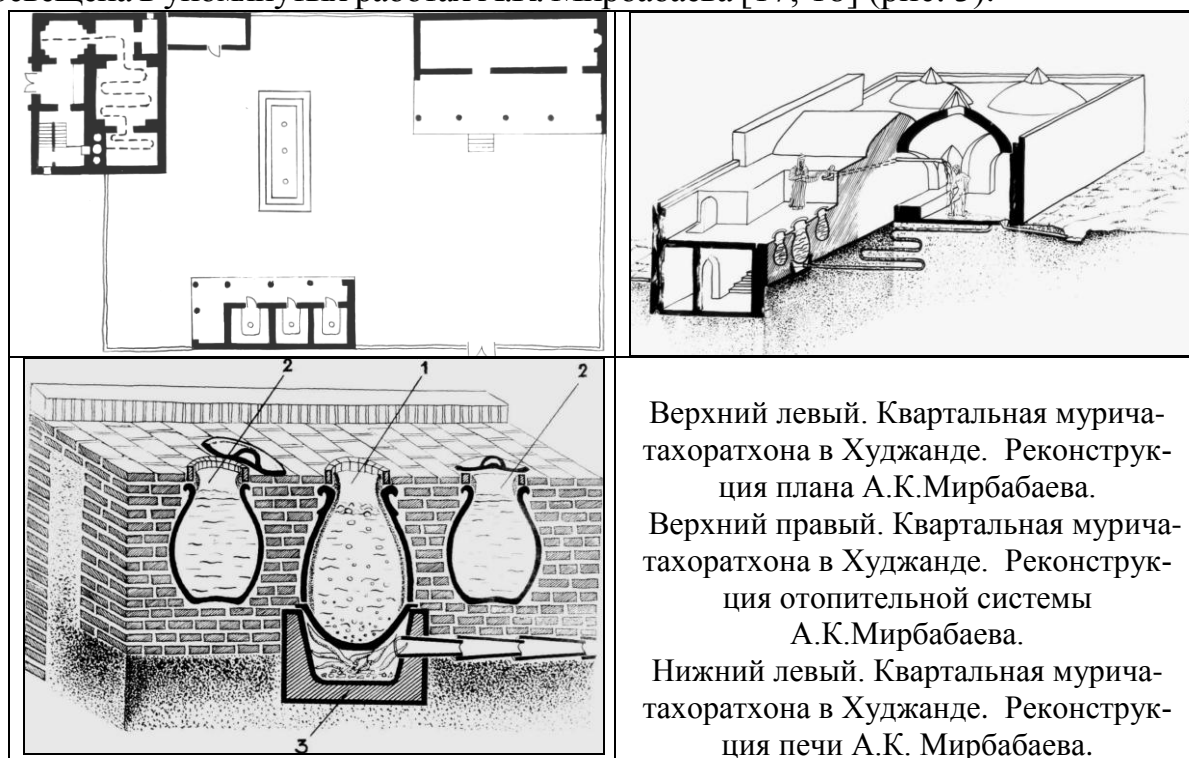
Рисунок 3 – Конструкции миниатюрных бань Худжанда
