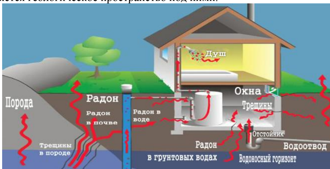
Рисунок 1 – Схема поступления радона в здания из геологического пространства под зданиями
