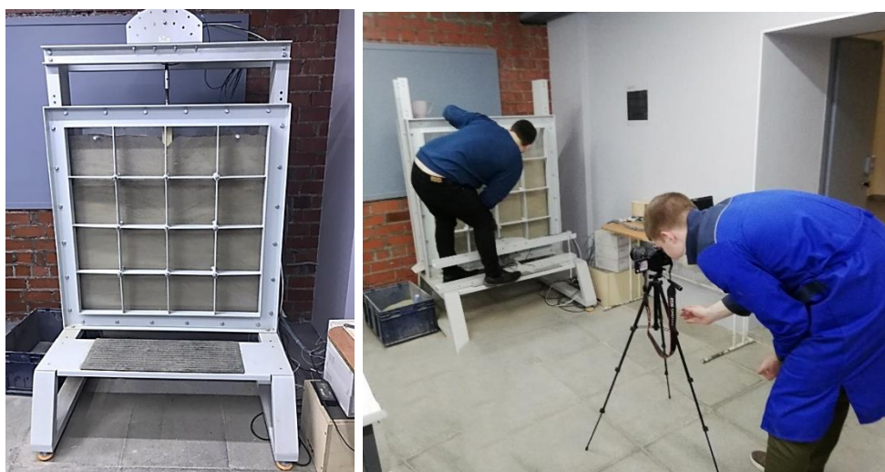
Рис. 1. Стенд для испытания моделей фундамента
