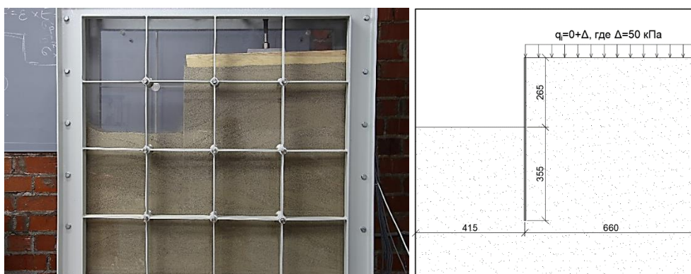
Рис. 2. Конструкция для исследования работы консольной подпорной стенки
