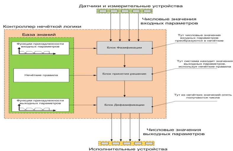
Рис. 1. Обобщенная структура измерительной систем с применением нечеткой логики
