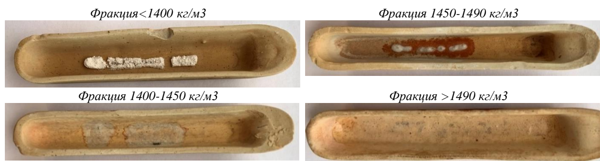
Рис.1. Зольный остаток различных фракций пшеничных отрубей после сжигания при 815°С
