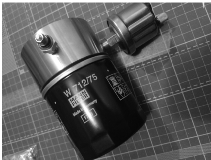
Рис.1. Проставка под масляный фильтр с датчиками давления и температуры
