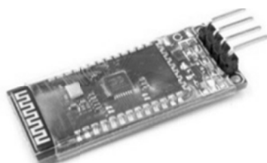
Рис. 1. Bluetooth модуль HC-06
