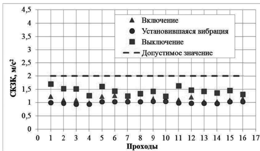
Рис.3. Результаты расчета значений средневекторного скорректированного виброускорения в процессе уплотнения грунта при движении вперед с максимальной вибрацией (08.08.2018 г)
