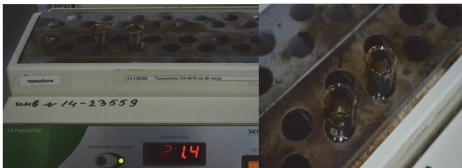
В пробирке без деэмульгатора разделение произошло на 5–6%, а в пробирке с деэмульгатором – на 8% от общего объема эмульсии.
