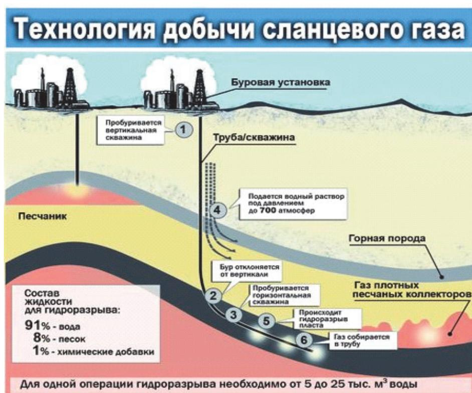
Схема 1. Добыча сланцевого газа при помощи «гидроразрыва»
