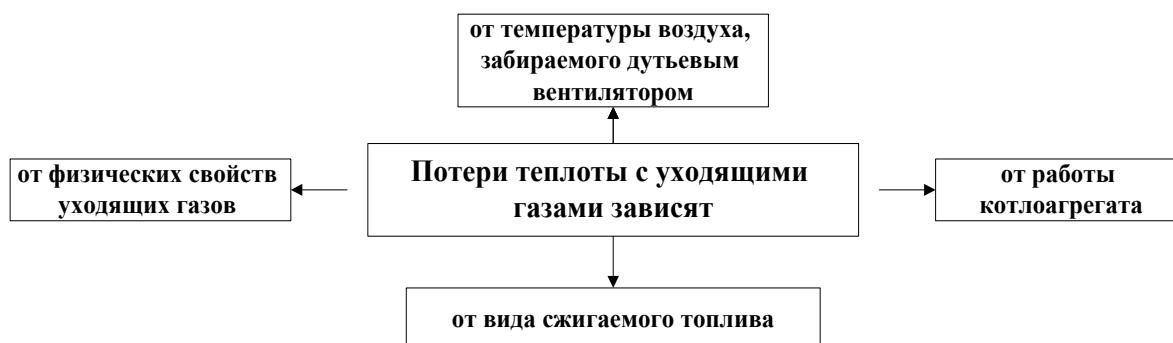
Рис.2 – Факторы, от которых зависят потери теплоты с уходящими газами.
