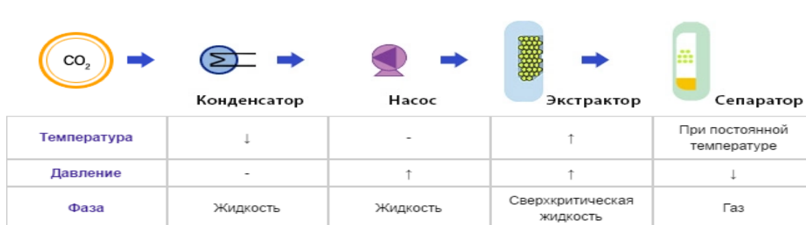
Рис.2 – Схема процесса экстракции сверхкритическим CO 2
