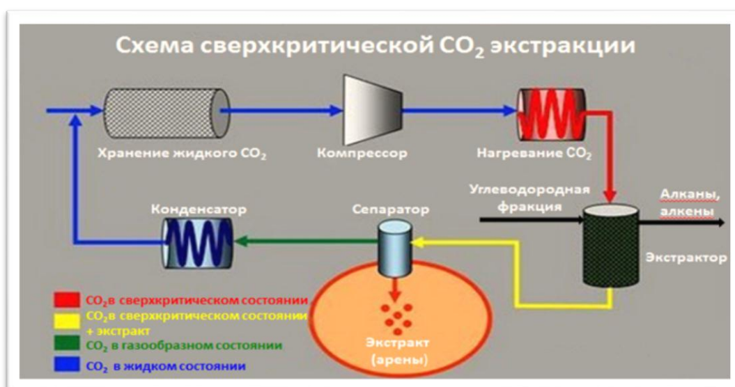
Рис.4 – Схема установки экстракции ароматических углеводородов сверхкритическим CO 2 .
