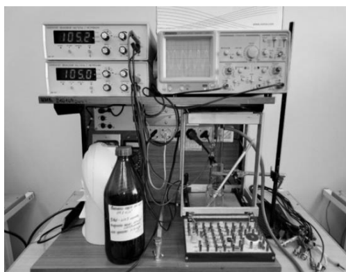
Рисунок 1. Лабораторный комплекс для исследования физико-химических свойств сложных смесей углеводородов
