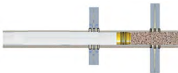
Рисунок 1. МГРП на ГС с применением мостовых пробок
