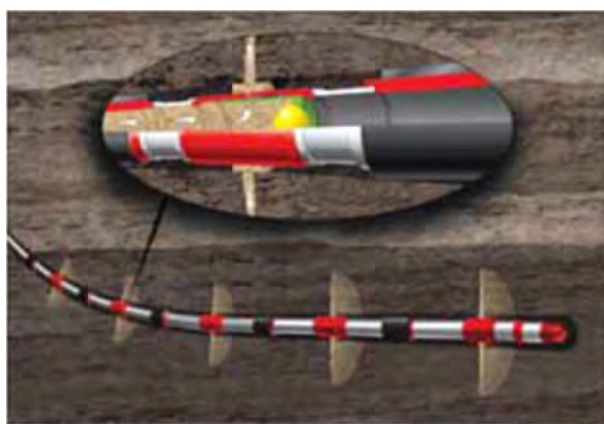
Рисунок 2. Технология многостадийного гидроразрыва пласта FracPoint™ на ГС с шаров ГРП и раздвижных муфт
