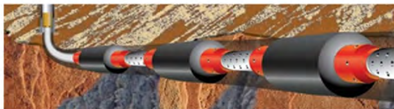
Рисунок 3. Технология МГРП для сегментированной адресной добычи на скважинах ВНС
