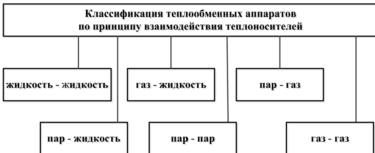
Рисунок 2. Классификация теплообменных аппаратов по принципу взаимодействия теплоносителей
