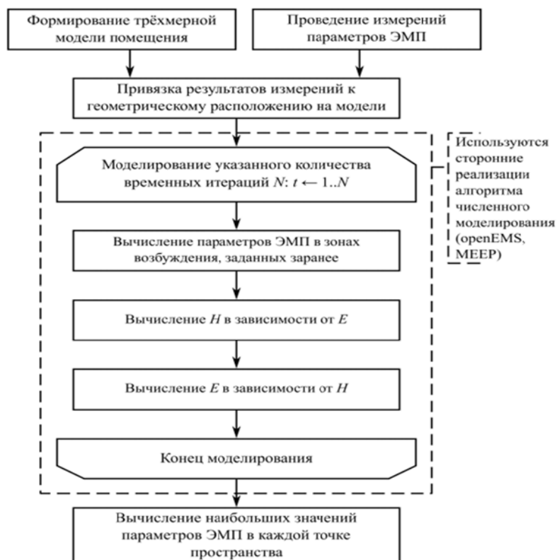
Рис. 3 – Блок-схема алгоритма моделирования электромагнитной обстановки в помещении методом конечных разностей во временной области
