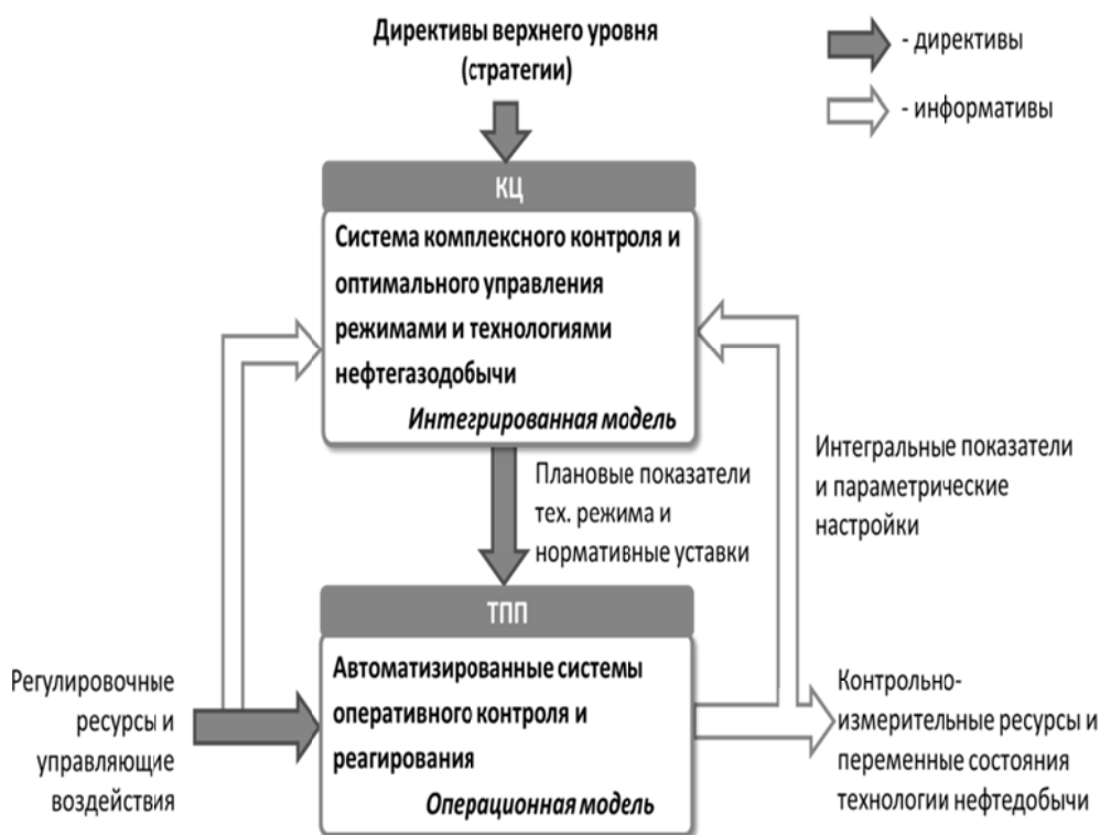
Рис. 1 – Функциональная схема управления процессами эксплуатации нефтяной скважины
