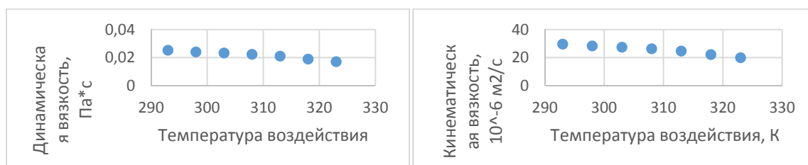
Рис. 2 – Графики зависимости вязкостей от температуры при воздействии магнитным полем
