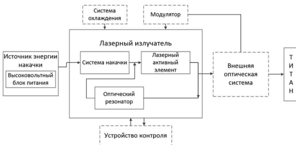
Рис. 1. Структурная схема лазерной установки
