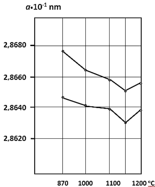
Рис. 3. Изменение периода решетки стали У8А в зависимости от температуры предварительной закалки и промежуточного отпуска
