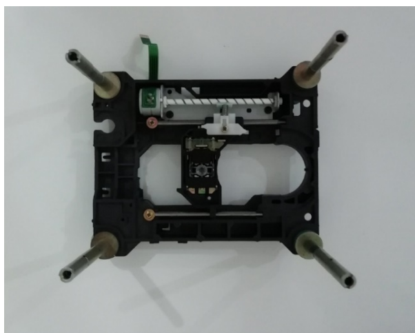
Рис. 3. Опытно-конструкторский узел блока лазерного излучения
