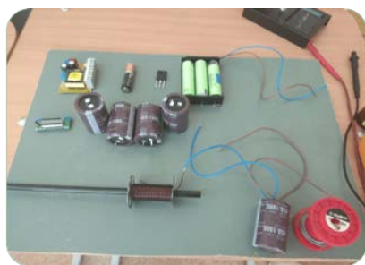
Рис. 3. Испытание опытного образца модели пушки Гаусса
