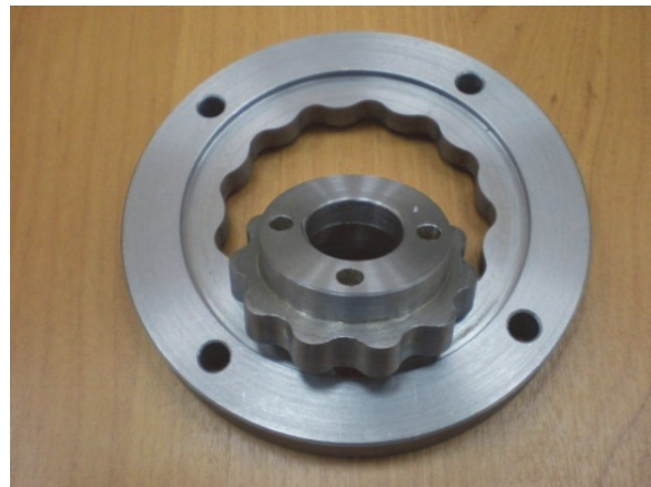
Рисунок 2.1.12. Пример изготовления кулачка на аппаратно-программном комплексе
