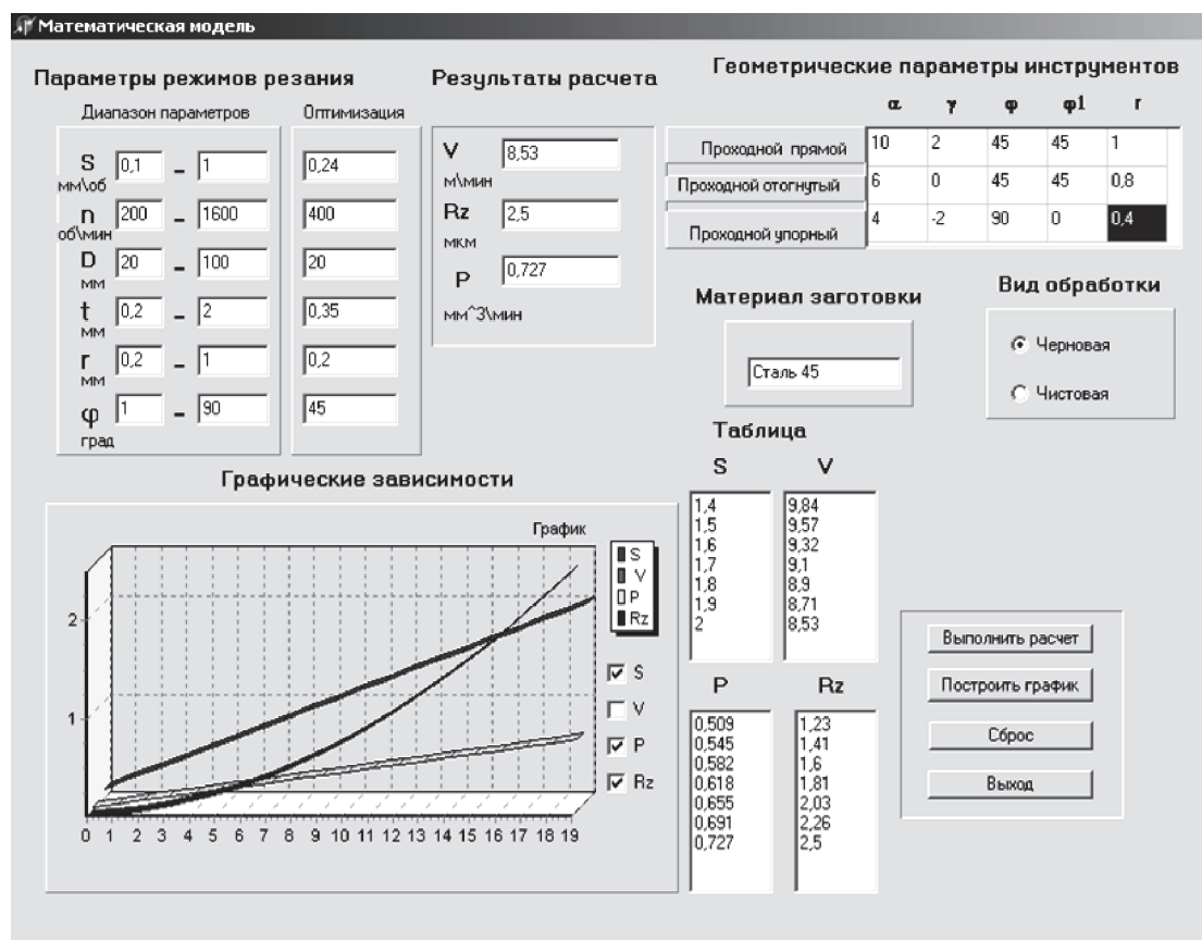
Рис. 2.2.9. Графический интерфейс для определения оптимальных режимов резания
