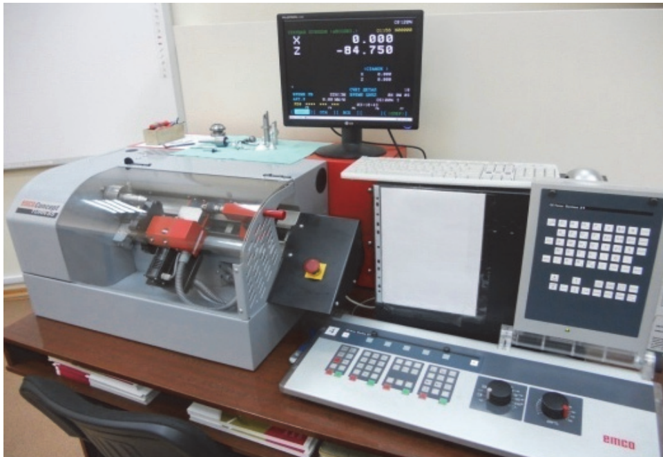
Рисунок 2.1.10. Отладка управляющей программы и обработка детали на токарном станке с ЧПУ
