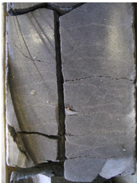
Рис. 2.8. Наклонные трещины, выполненные кальцитом, глубиной 2615,8 – 2616,0 м
