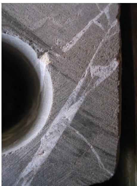
Рис. 2.6. Наклонные трещины, выполненные кальцитом, глубиной 2617 м
