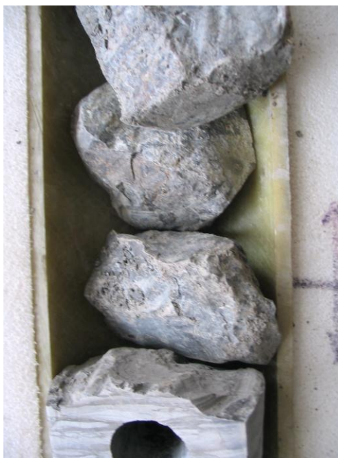
Рис. 2.4. Керн, представленный неправильными обломками пород в зоне повышенной трещиноватости, глубиной 2637 м
