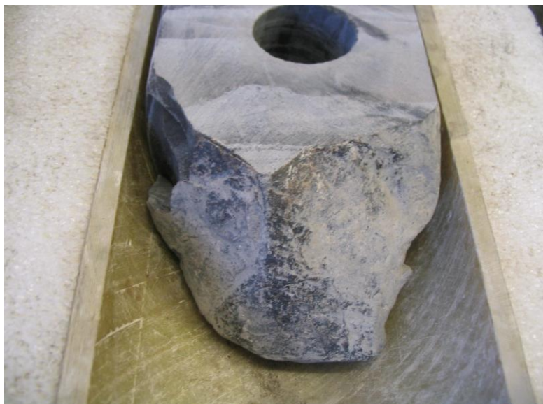
Рис. 2.3. Разноориентированные наклонные трещины в породах турбидитной серии с прослоями известняков глубиной 2636,5 м
