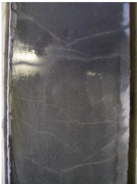
Рис. 2.7. Хаотические трещины в известняках баженовской свиты глубиной 2615,4 м
