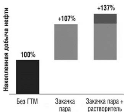
Рисунок 5. Эффективность комплексной технологии обработки ПЗП закачкой пара и растворителя на высоковязком месторождении
