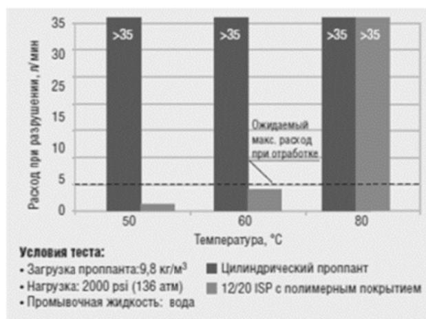
Рисунок 3. Проведение испытаний по сравнению цилиндрического и сферического проппантов на стабильность
