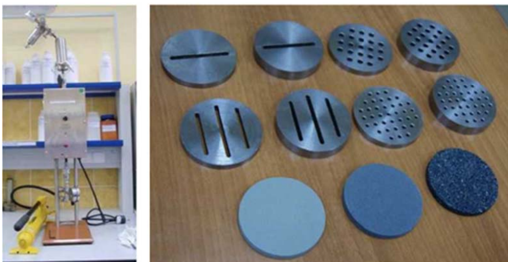
Рисунок 3. Приборы для оценки эффективности материалов для ликвидации поглощений
