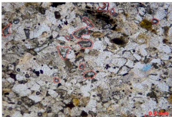
Рисунок 1. Участок шлифа после многочасовой выдержки в растворителе.
