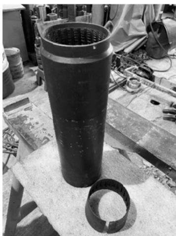
Рисунок 3. Компоновка КРЦ с цанговым кернорвателем БОЦК-100.01
