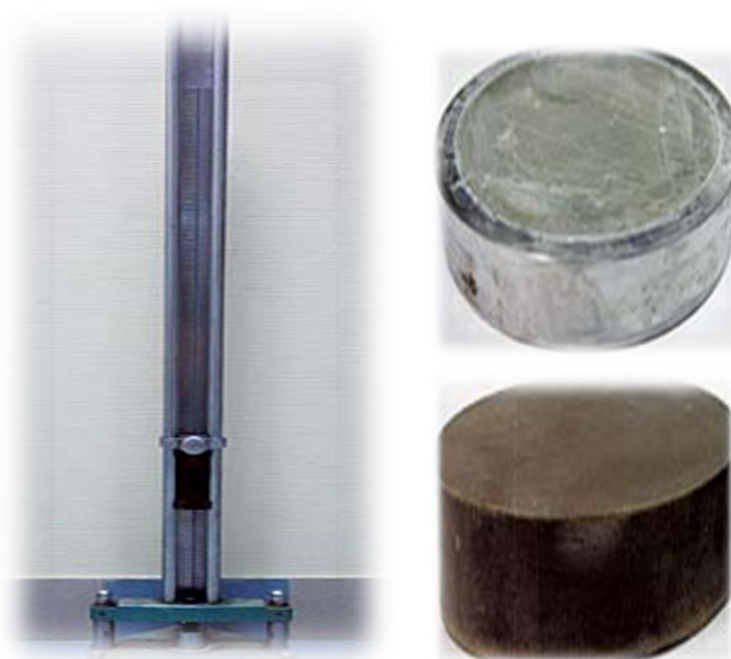
Рисунок 1. Прибор для определения прочности покрытий при ударе с испытываемыми цементными дисками
