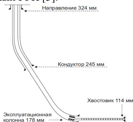
Рисунок 1. Типовая конструкция горизонтальной скважины с фильтром-хвостовиком в интервале продуктивного пласта
