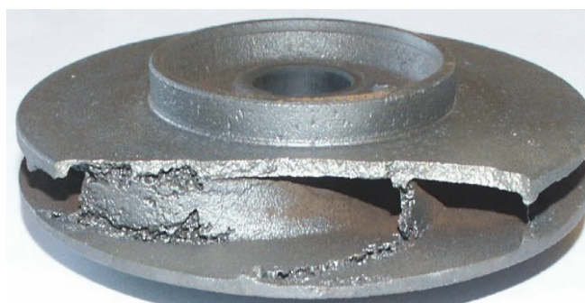
Рисунок 2 – Кавитационная эрозия рабочего колеса
