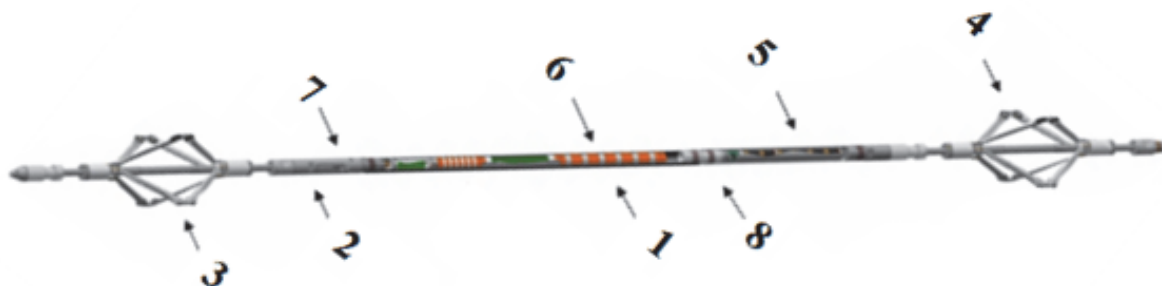
Рисунок 3 – Прибор EmPulse: 1 – длинный зонд, 320мм; 2 – манометр; 3 – нижний центратор; 4 – верхний центратор; 5 – отсек батарей; 6 – титановый корпус; 7 – датчик температуры; 8 – память
