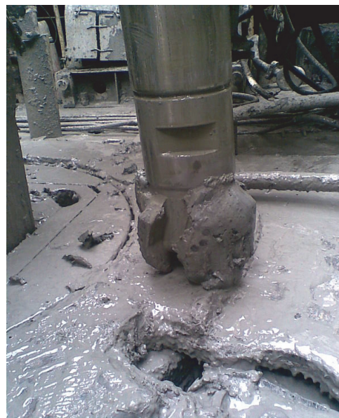
Рисунок 1 – Фотографии сальников на буровом инструменте
