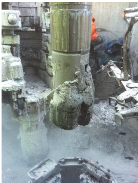
Рисунок 1 – Фотографии сальников на буровом инструменте
