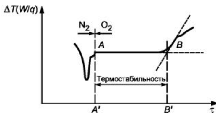
Рисунок 1 – Стандартная термограмма для термостабильности полиэтилена
