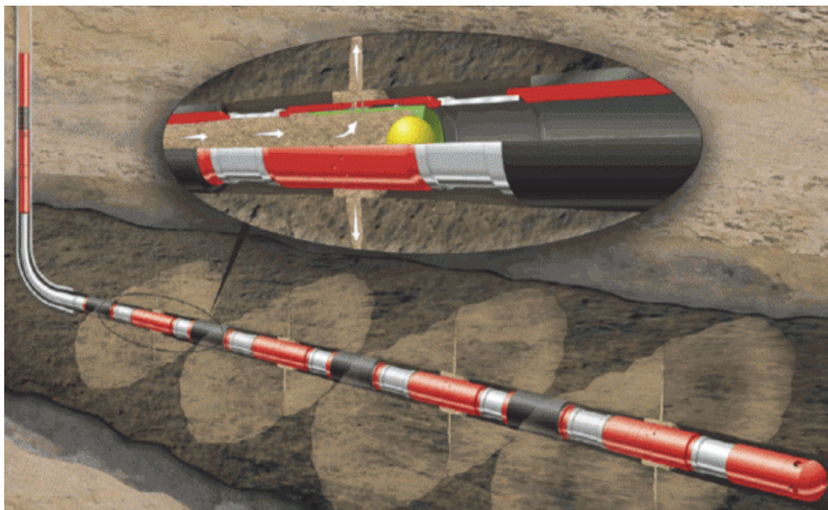
Рисунок 2 – Технология МГРП с применением раздвижных портов
