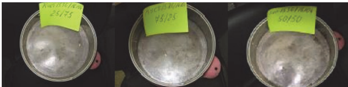
Рисунок 2 – Совместимость КСПВ/нефти после 30 мин при температуре 70°C, осадка не обнаружено
