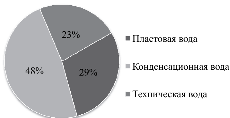
Рисунок 1 – Результаты химического анализа воды в обводненных скважинах Ямбургского НГКМ
