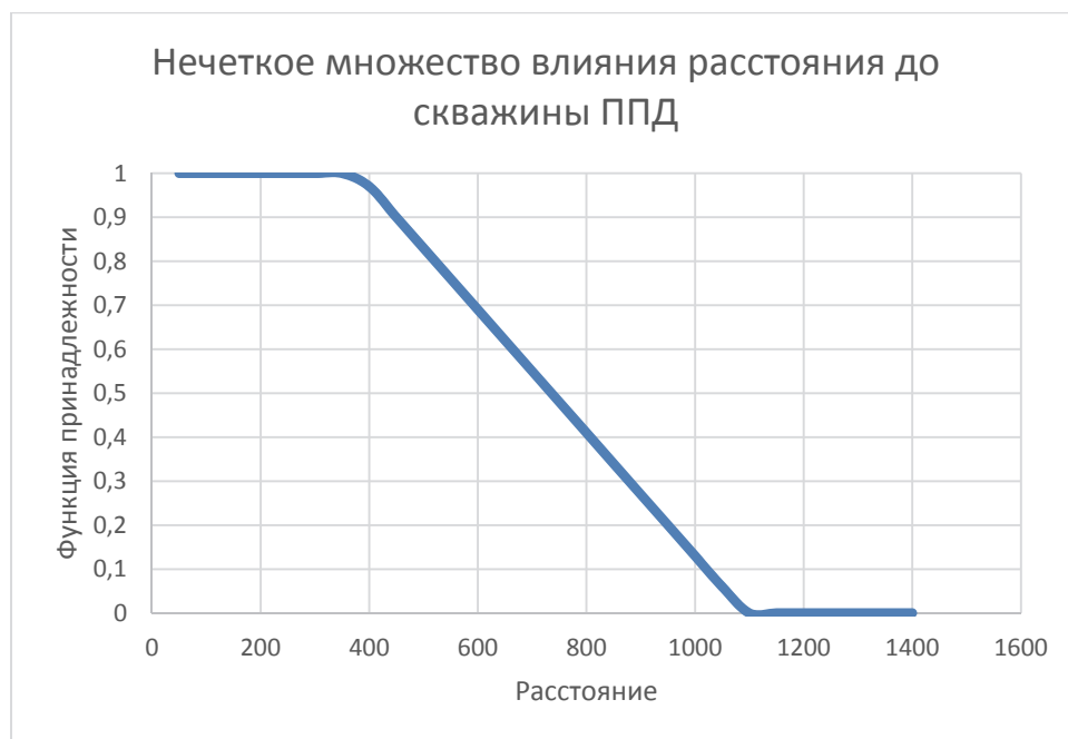
Рисунок 1 – Функция принадлежности нечеткого множества влияния расстояния до скважины ППД
