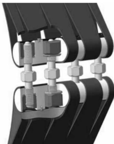
Рисунок 2. Конструкция узла затяжки
