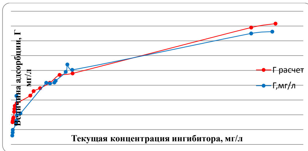
Рисунок 1. Изотерма адсорбции ингибиторов Descum-2 марки Н-3611-А, Descum-4 марки S на породах керна пласта Западно-Аганского месторождения
