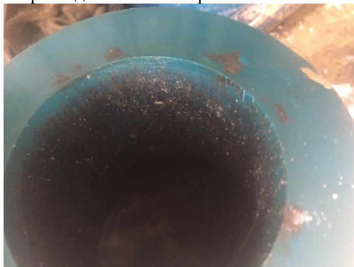
Рисунок 4. Изношенный сальник вращающегося отклонителя потока
