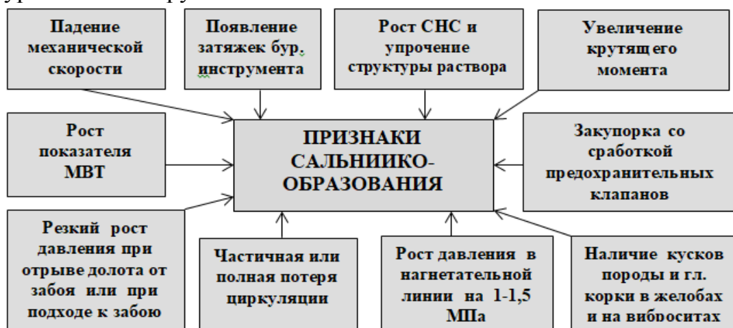
Рисунок 2. Схема признаков сальникообразования
