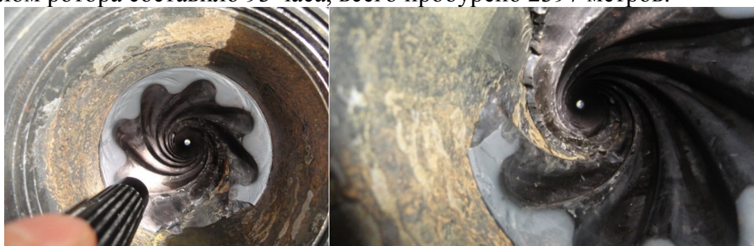
Рисунок 2. Изношенная двигательная секция
