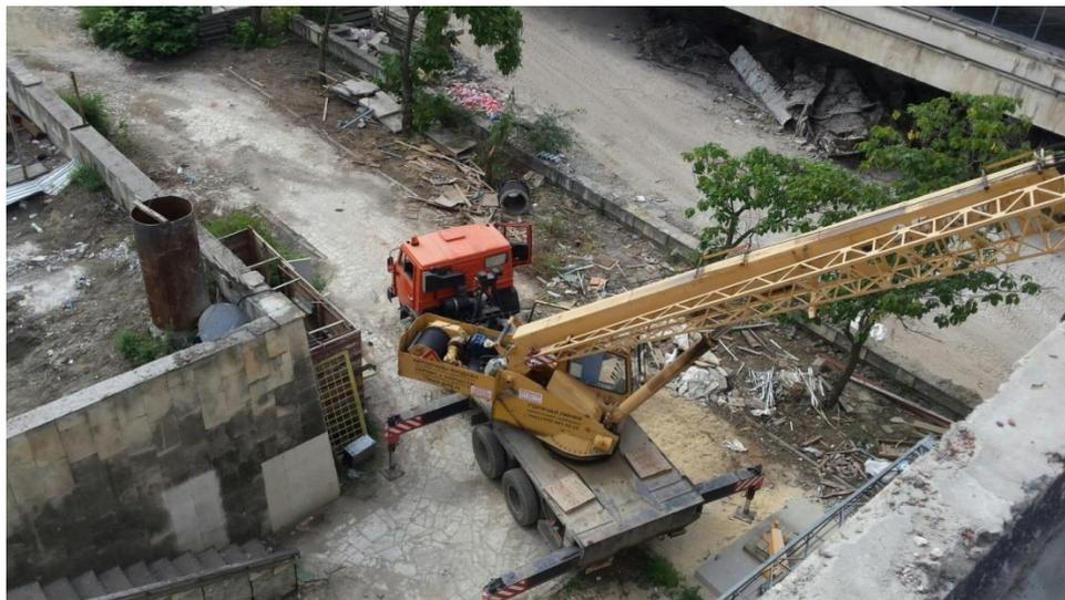
Рис. 5. Установка в рабочее положение машинного крана (Автор)
