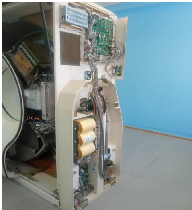
Рисунок 3- Вид боковой панели томографа.
