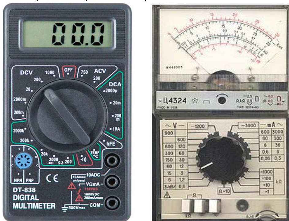
Рис. 2.1. Цифровой и аналоговый мультиметры
