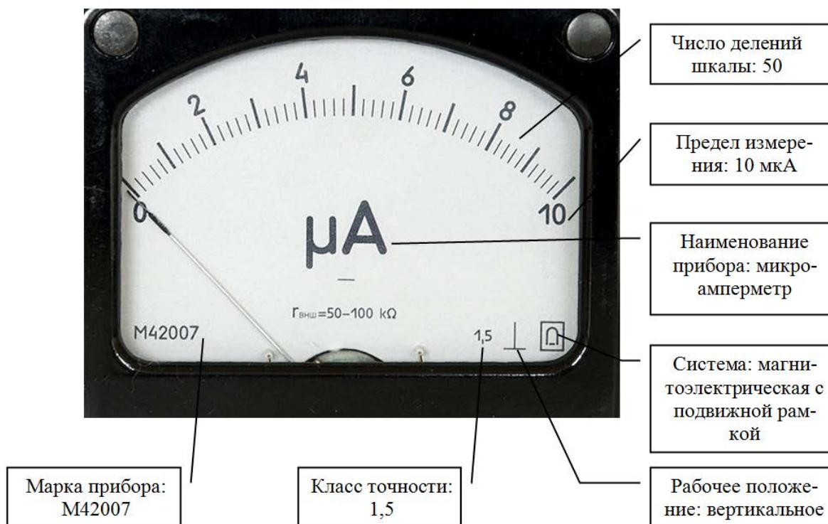
Рис. 1.4. Характеристики микроамперметра
