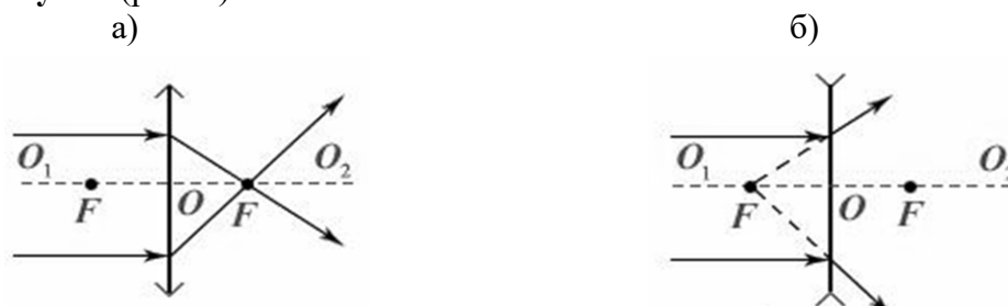
Рис. 4. Действие линз и их условное обозначение
