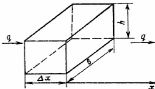
Рисунок 5.1 – Элемент прямолинейного пласта
