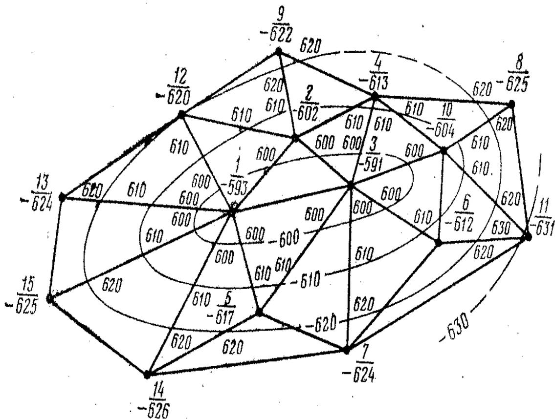
Рисунок 2 - Построение структурной карты по способу треугольников в числителе дроби – номер скважины, в знаменателе – абсолютная отметка кровли (подошвы) пласта
