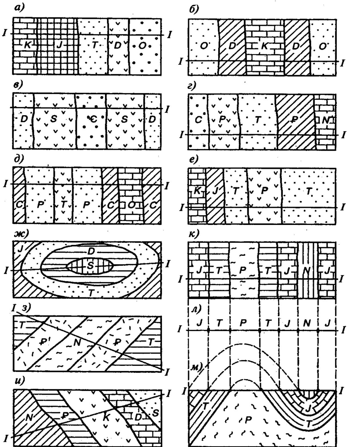
Геологические разрезы показывают геологическое строение земли по какой-то линии, которую называют линией разреза. Разрезы показывают, как залегают слои пород, их литологический состав, мощность и возраст слоев, глубину уровня грунтовых вод. В том случае, когда на разрезах показаны свойства пород и геологические процессы, их называют инженерно-геологическими.
