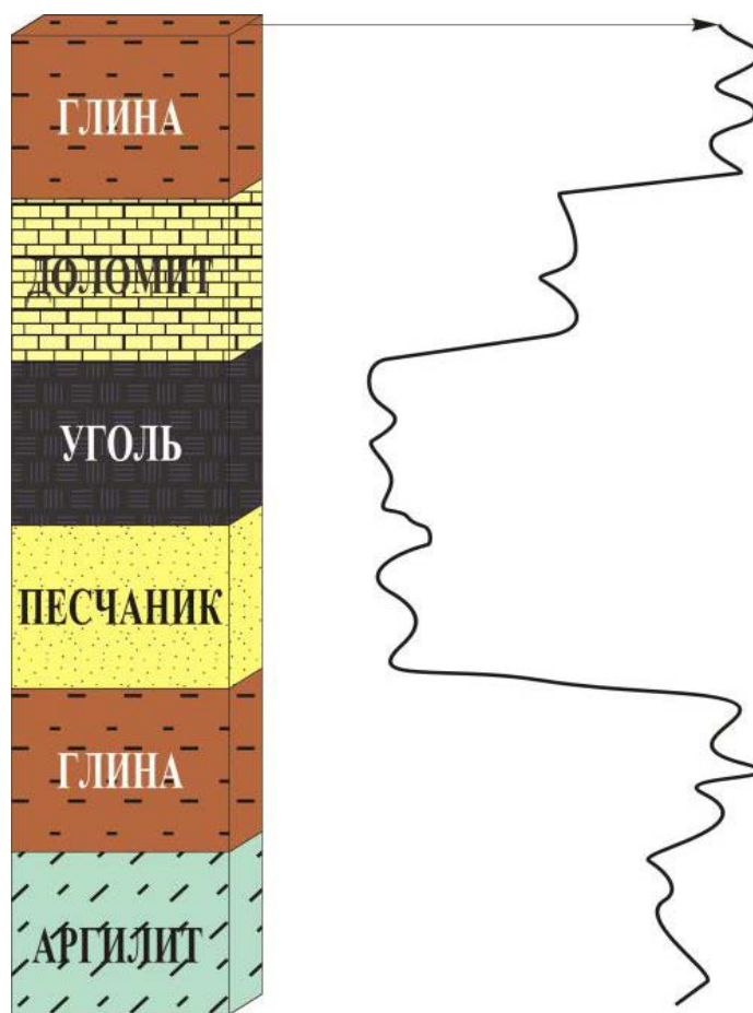
Рисунок 8 – Диаграмма ГК против пород разной литологии
