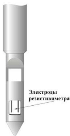
Рисунок 7 – Токосый резистивиметр прибора К-3
