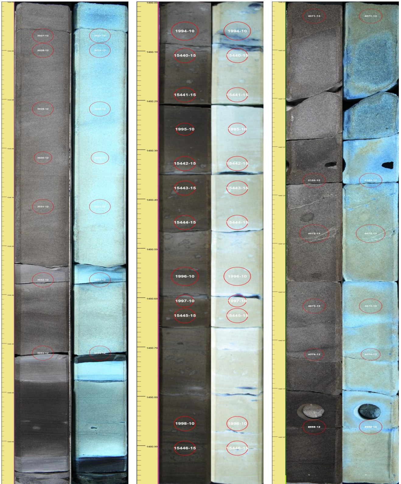
Рисунок 3.10 – Фотографии колонок однородного керна (возможно изготовление только однородных образцов)
