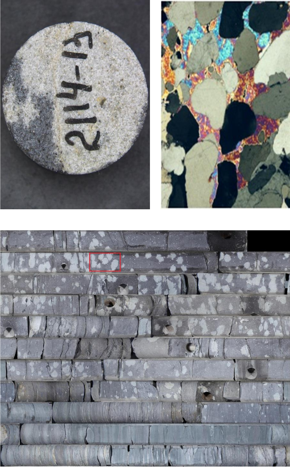
Рисунок 1.10 – Распределение пятнистых включений по фотографии колонки керна, образцов и на микроуровне в шлифах горных пород хамакинского горизонта
