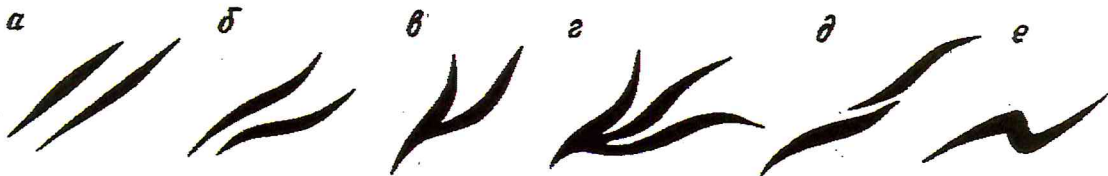
Рис. 7 - Типы складок в плане: а – прямолинейные, б – дугообразно изогнутые, в – ветвящиеся, г – виргирующие, д – кулисообразные, е – сигмовидная
