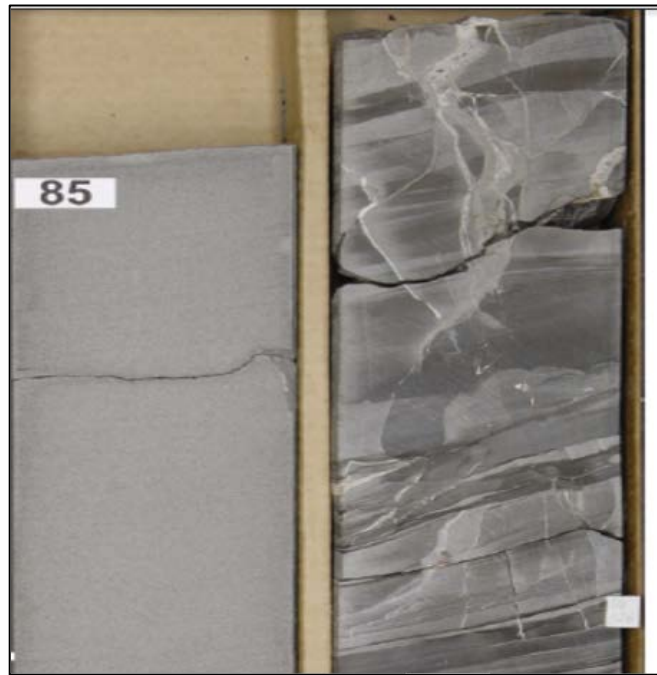
Рисунок 71 - Фрагмент керна скважины № 195Р Свободного месторождения с нарушением сплошности породы вертикальными трещинами, заполненных вторичным минералообразованием, интервал 2902.3-2902.6м, подошва пласта ЮВ-1.
