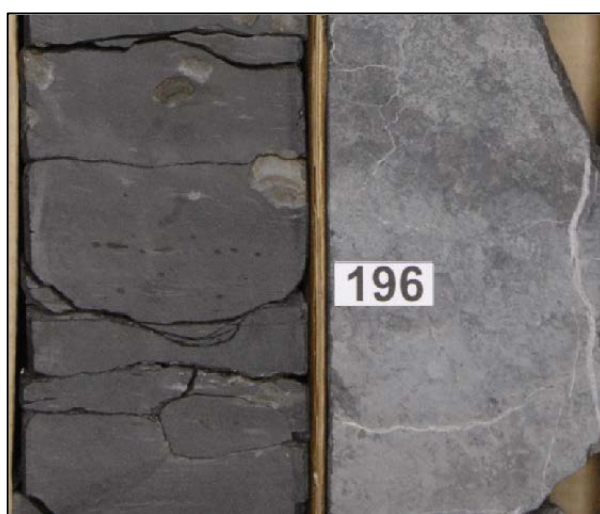
Рисунок 67 - Фрагмент керна пласта ЮВ-1 с нарушением сплошности по линиям неоднородности (слева), трещины заполнены вторичным кальцитом (справа), скважина № 70Р Повховского месторождения.
