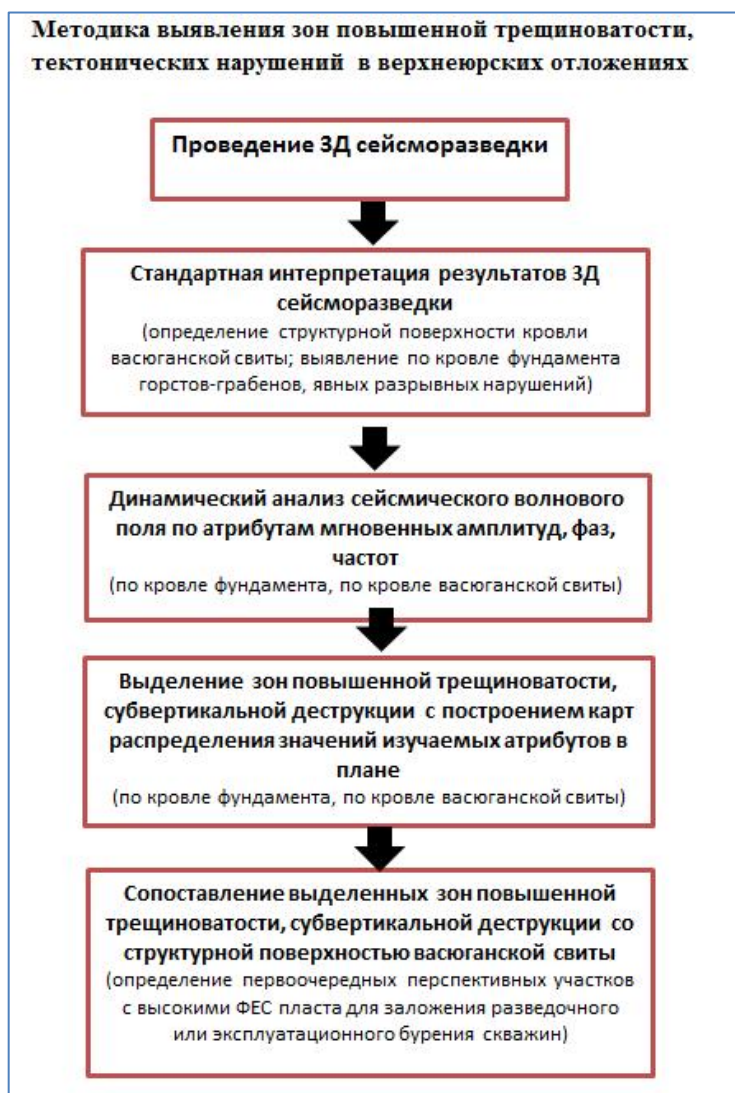
Схема №1 - Методика по выделению зон повышенной трещиноватости и тектонических нарушений верхнеюрских отложений.
