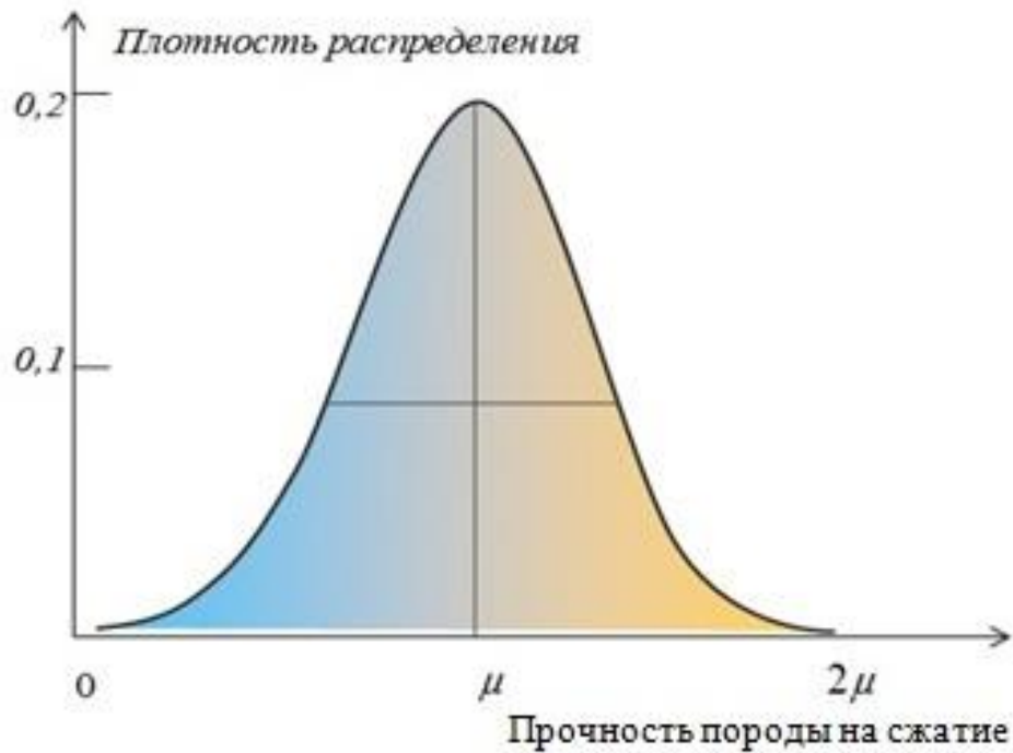
Рисунок 3.5 - Симметричные участки под кривой нормального распределения прочности породы на сжатие (или на растяжение)
